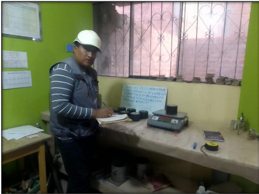
Se muestra en la figura realizando el pesado de las briquetas.
