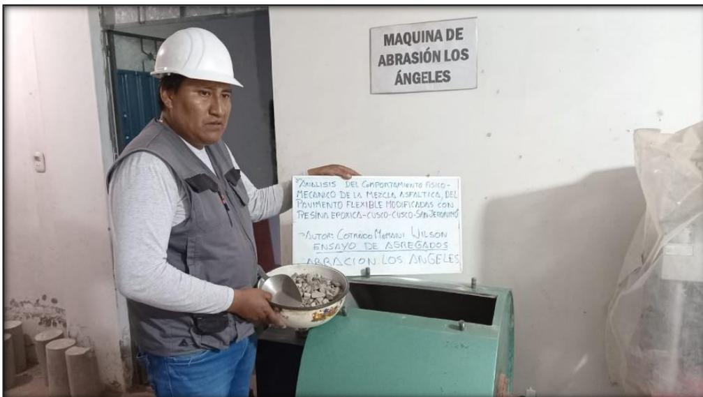
Se muestra en la figura agregando el agregado para el control de su dureza.
