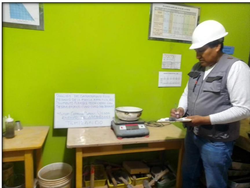
Se muestra en la figura pesando el agregado para su control.
