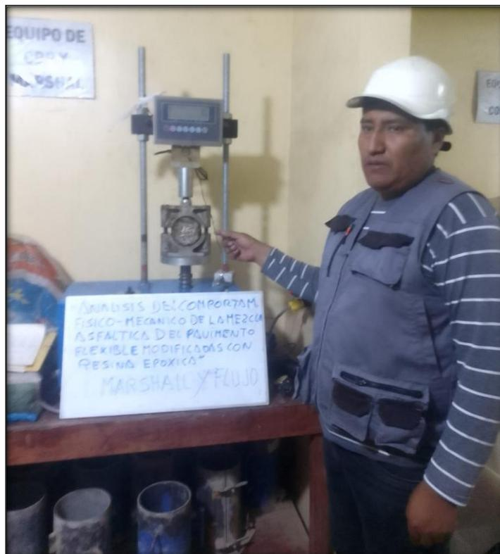
Se muestra en la figura realizando la prueba de Marshall.
