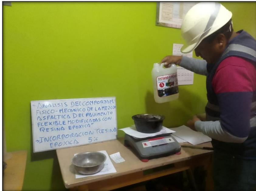
Se muestra en la figura agregando la resina epoxica en un 5%
