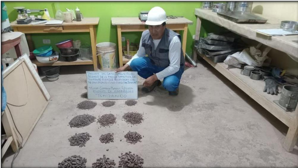
En la figura se muestra los resultados de los diferentes tamaños del agregado.
