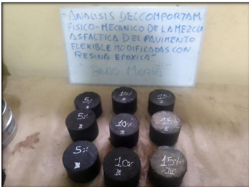
Se muestra en la figura las briquetas realizadas con diferentes % de Resina Epóxica
