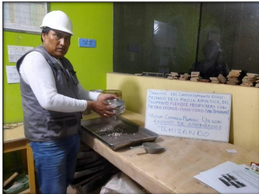
Se muestra en la figura el tamizado del agregado en el laboratorio.
