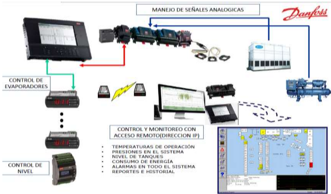
Figura 30: Monitoreo a distancia del sistema de frio con software Danfoss, cámaras de frio.
