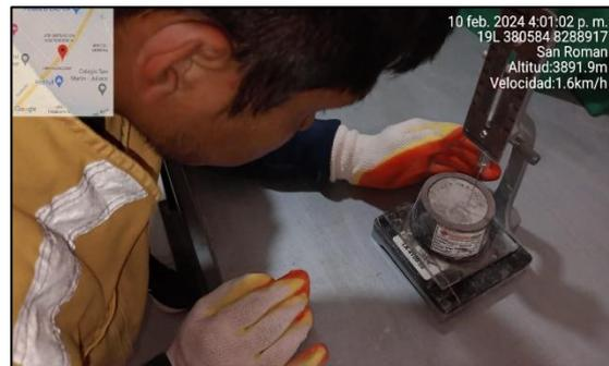
Figura 24. Ensayo de tiempo de fraguado del cemento
