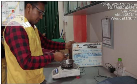
Figura 27. Ensayo de finura del cemento
