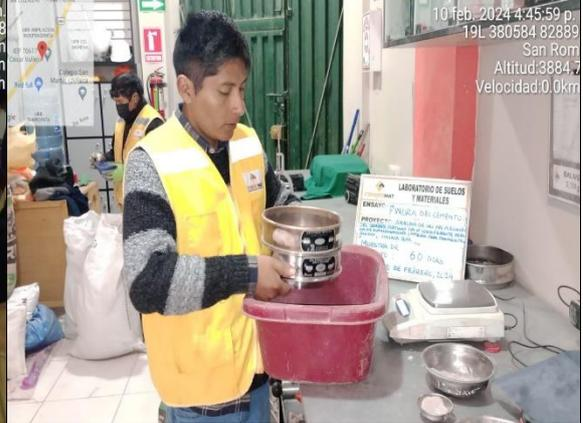
**Figura 8.** Tamizado de la muestra de cemento
