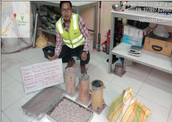
**Figura 9.** Preparación de los componentes del concreto
