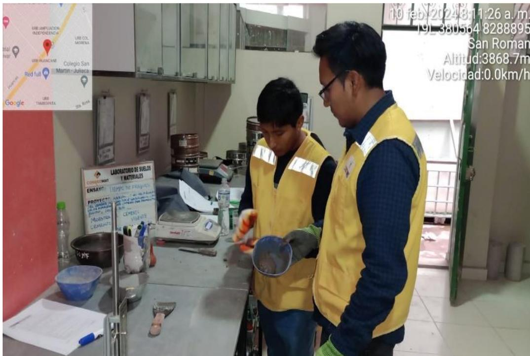
Figura 7. Preparación de la muestra para el ensayo de consistencia normal del cemento
