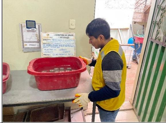
**Figura 14.** Curado de los cubos de mortero de cemento
