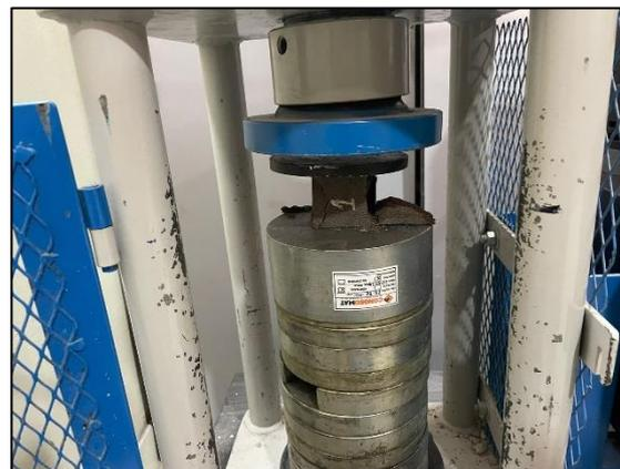
Figura 31. Rotura de los morteros de cemento
