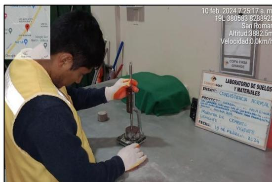
Figura 21. Aparato de Vicat para el ensayo de consistencia normal del cemento
