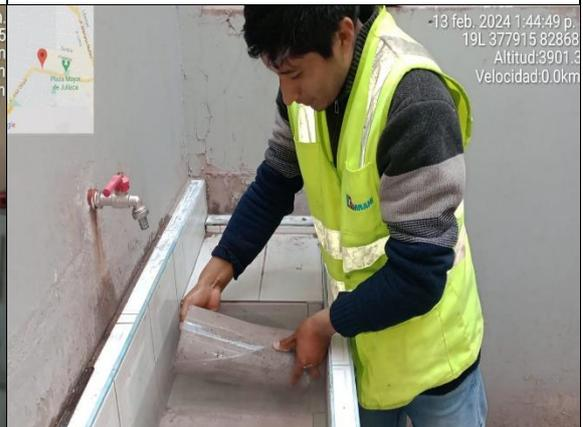
**Figura 12.** Curado de las probetas de concreto
