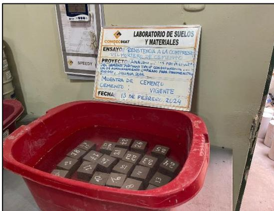
Figura 30. Morteros de cemento previo a la rotura
