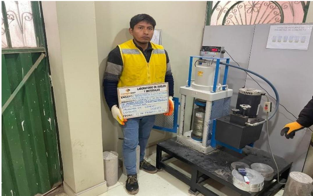
Figura 13. Rotura de los cubos de mortero de cemento
