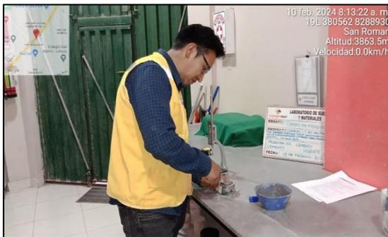
Figura 23. Colocado de la muestra en el aparato de Vicat
