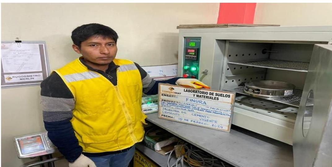
Figura 11. Secado en horno del tamiz y de la muestra de cemento
