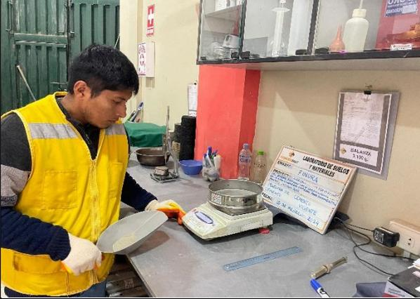
**Fotografía 19.** Pesado del tamiz en la balanza electrónica
