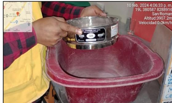
Figura 28. Tamizado del cemento mediante el tamiz #325
