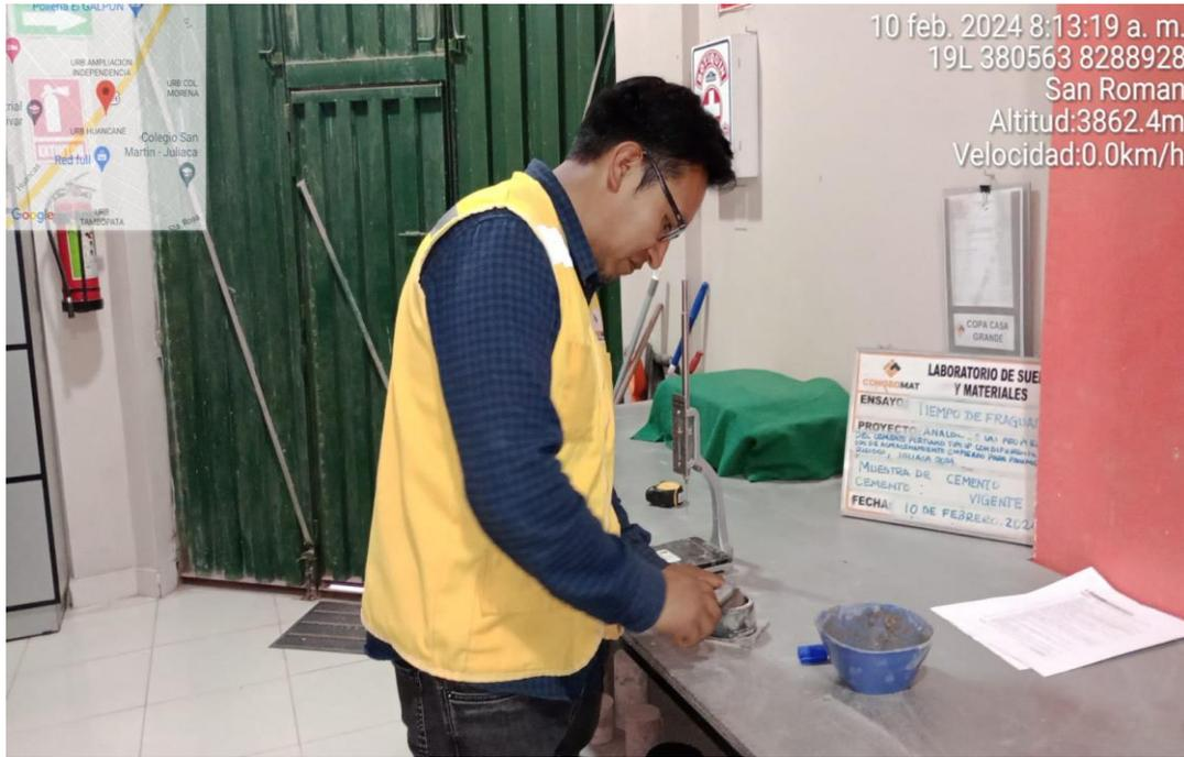
Figura 9. Ensayo de tiempo de fraguado
