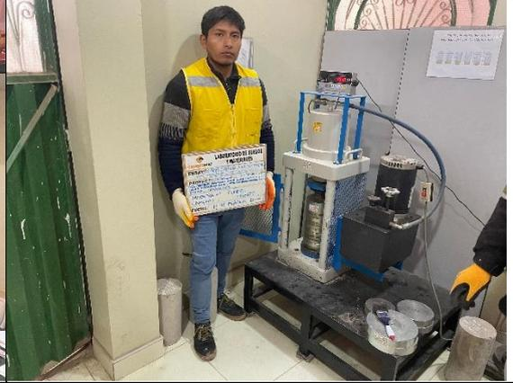
**Figura 20.** Rotura de los cubos de mortero de cemento
