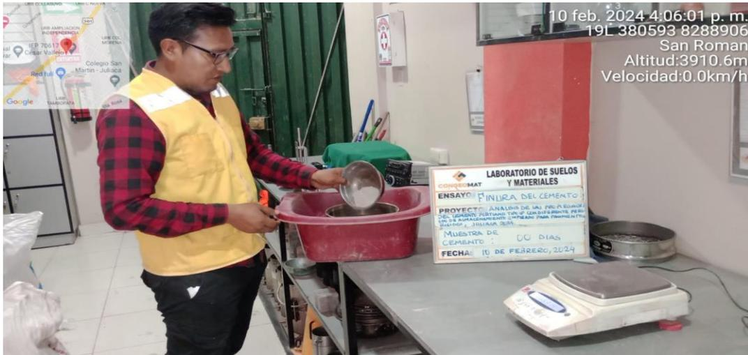
Figura 10. Tamizado de la muestra de cemento
