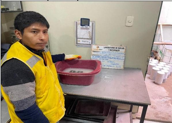
**Figura 15.** Curado de los cubos de mortero de cemento
