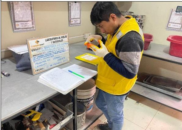
**Figura 17.** Medición de los lados de los cubos de mortero de cemento
