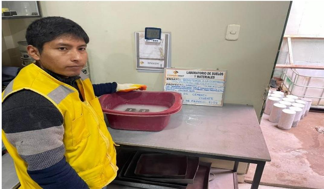
*Figura 12. Curado de los cubos de mortero*
