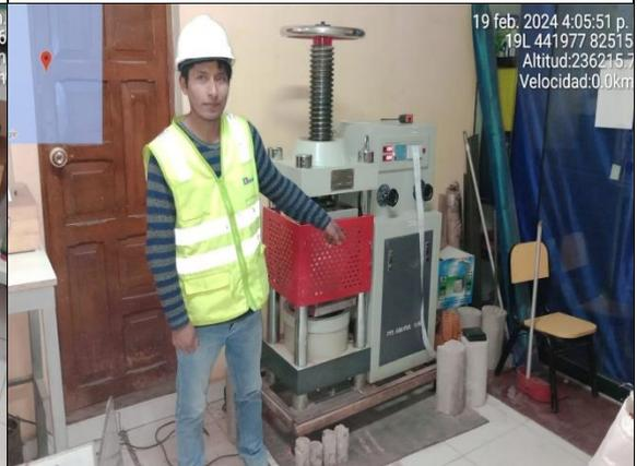
**Figura 10.** Rotura de las briquetas de concreto
