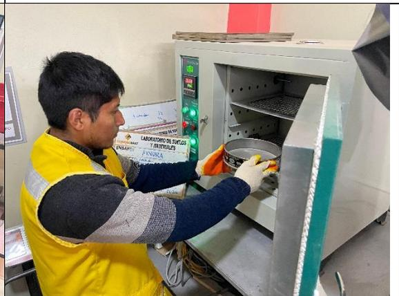
**Figura 18.** Secado de la muestra de cemento luego del tamizaje
