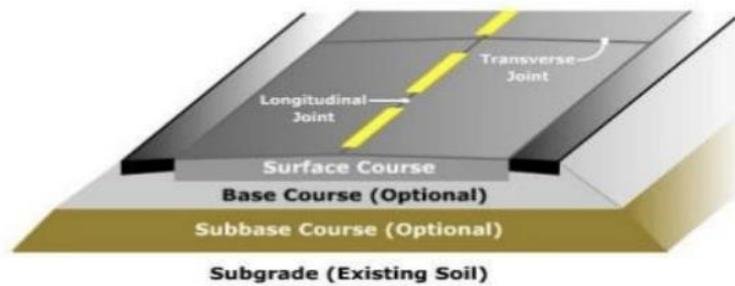
Figura 5. Losa de concreto en un pavimento rígido
