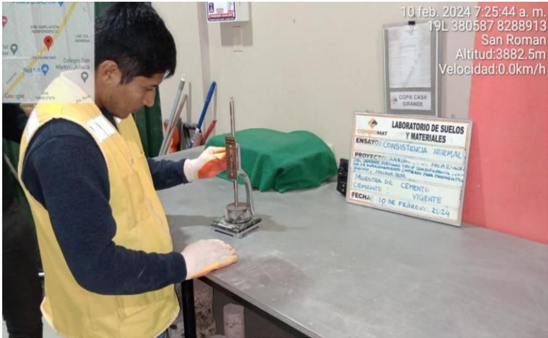
Figura 8. Ensayo de consistencia normal del cemento
