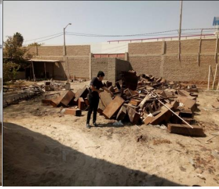
Figura 34. Cubetas con presencia de óxido
