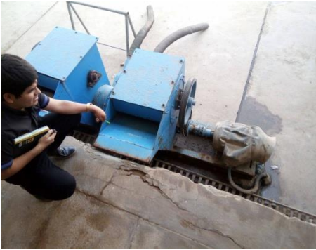
Figura 35. Cortadora sin guarda
