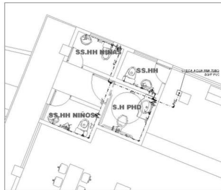
AMPLIACION SS.HH SEGUNDO PISO - BLOQUE BIBLIOTECA ESC: 1/75
