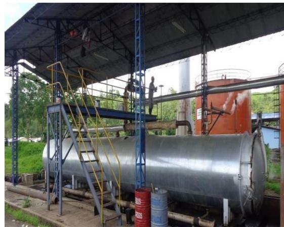
Observamos que el esterilizado se encuentra ubicado al aire libre con una cobertura de metal para la mejor ventilación porque es una máquina que funciona vapor.
