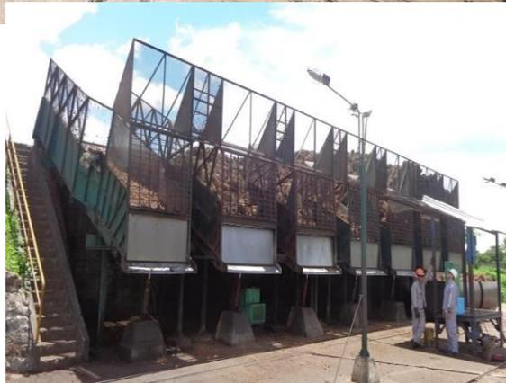
En la siguiente imagen observamos la construcción de dos tipos de tolvas: una hecha de madera y la otra mecánica que sirven para abastecer los candilones o los vagones para ser trasladados a los esterilizados. Cada espacio de la tolva puede almacenar hasta 8 toneladas de RFF.
