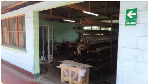
En el taller observamos que está construido de material noble con cobertura liviana de calamina con un piso de cemento pulido y sistema de ventilación e iluminación natural.
