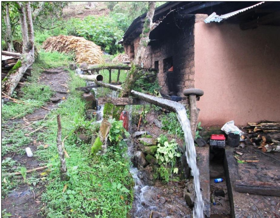
**FOTO N° 13:** En la imagen se aprecia el cálculo del caudal de la quebrada de Anshe pro el método volumétrico.
