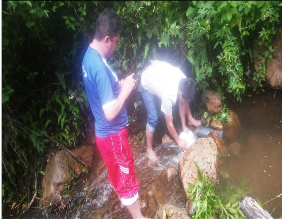
**FOTO N° 14:** En la imagen se aprecia el cálculo del caudal de la quebrada de Anshe pro el método volumétrico.
