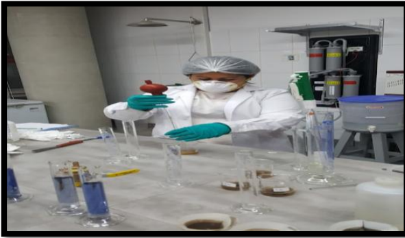
Figura N° 20: Se colocó 3ml de la muestra Fig.16 y 10ml del reactivo combinado y se dejó depositar por 30min
