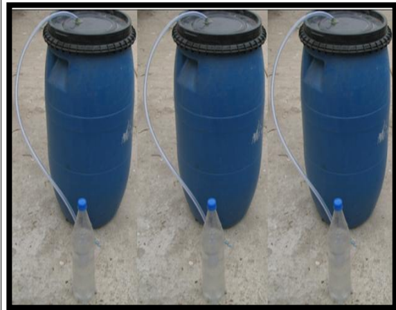
Figura N° 10: se hace un pequeño hueco en la parte de la tapa, para colocar la manguera de \frac{1}{4} de diámetro, se le agrega soldimix para evitar el ingreso de oxígeno
