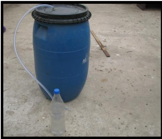
Figura N° 11: se coloca una botella de 1L con agua, para la fuga de los gases y no ingrese oxígeno
