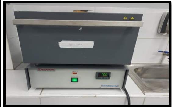
Figura N° 23: La muestra se llevó a la mufla por 4hrs a 550°
