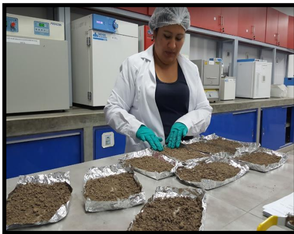
Figura N° 16: Se procedió a colocar 200g de la muestra del suelo con tratamiento en el papel aluminio.
