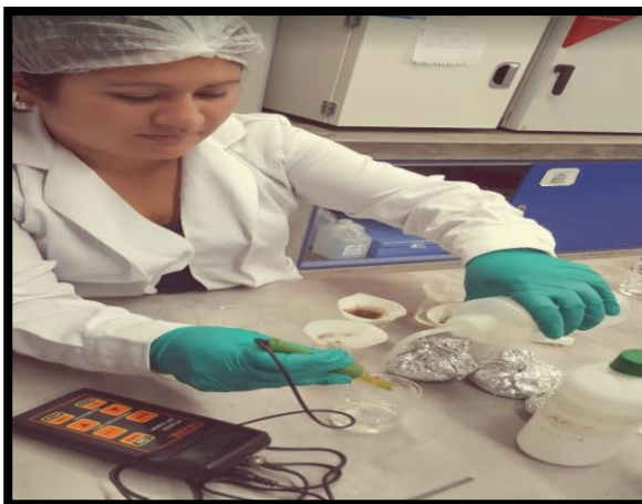
Figura N° 18: Se realizó la medición del pH y C.E (1:1)
