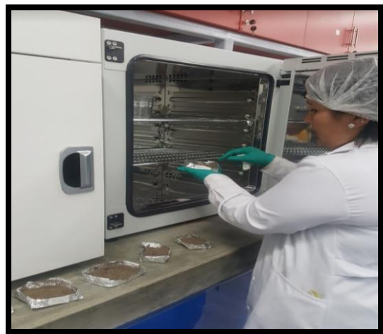
Figura N° 17: Se colocó la muestra del suelo con tratamiento en la estufa, para posterior a ello se realice el tamizado.
