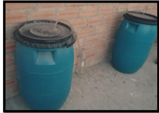
Figura N° 10: se hace un pequeño hueco en la parte de la tapa, para colocar la manguera de \frac{1}{4} de diámetro, se le agrega soldimix para evitar el ingreso de oxígeno
