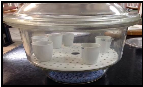
Figura N° 24: Se colocó la muestra por 1hr en el desecador
