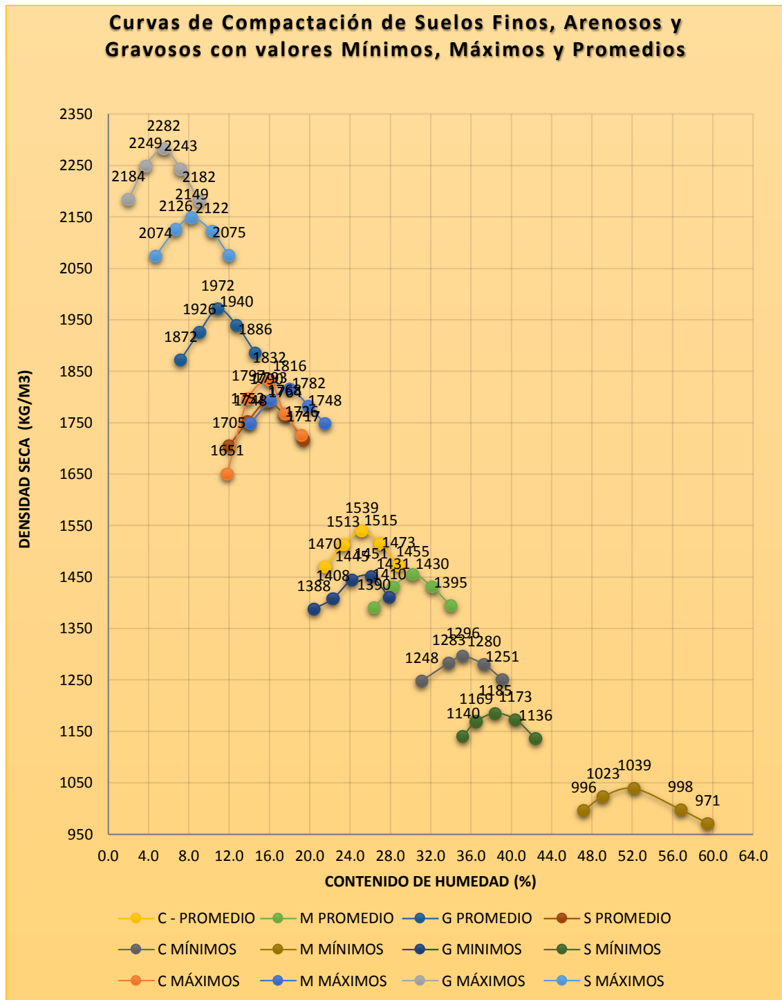
Figura 98. Gráfica de las “curvas de compactación” para las categorías de suelos “gravosos (G), arenosos (S) y finos (C y M)” – con valores máximos, promedios y mínimos.
