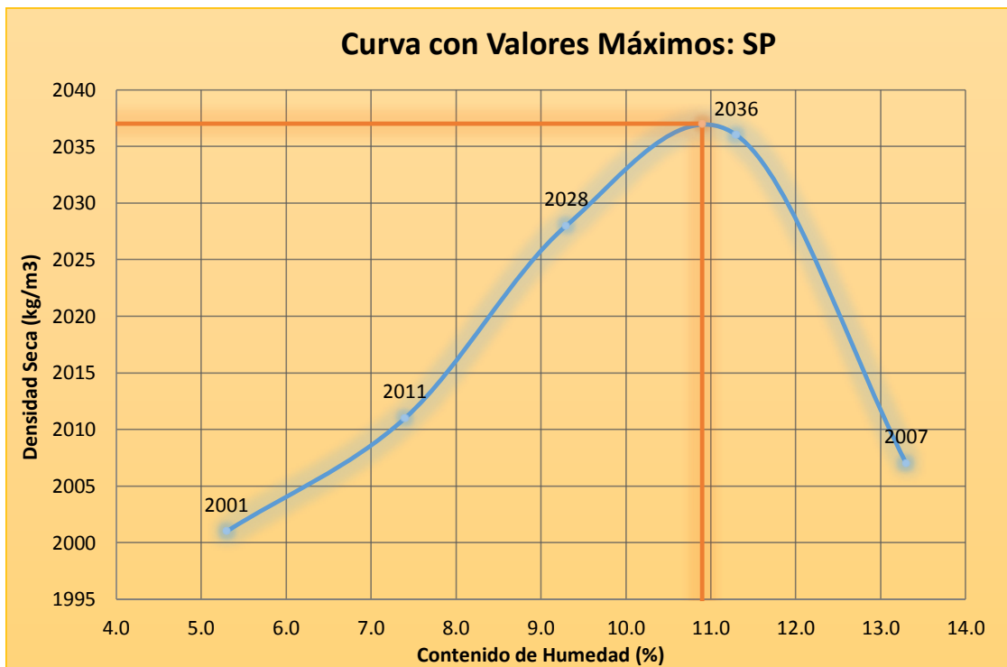
Figura 53. Gráfica de la “curva de compactación” para la subdivisión de suelos “arena pobremente graduada (SP)” – con valores máximos.
