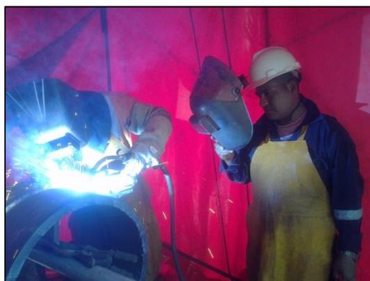
Figura 06 Soldeo de Probeta con FCAW
