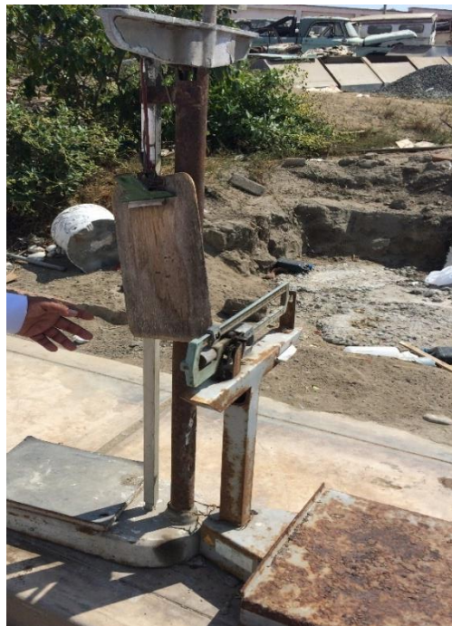
Se evidencian la balanza de residuos comunes en mal estado.
