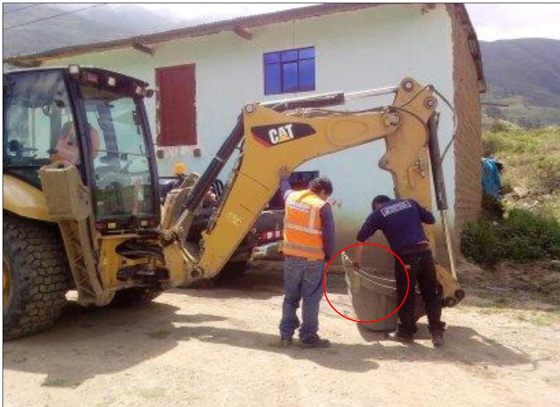
Foto N° 05: Ruptura de las uñas de la cuchara Fuente: El autor
