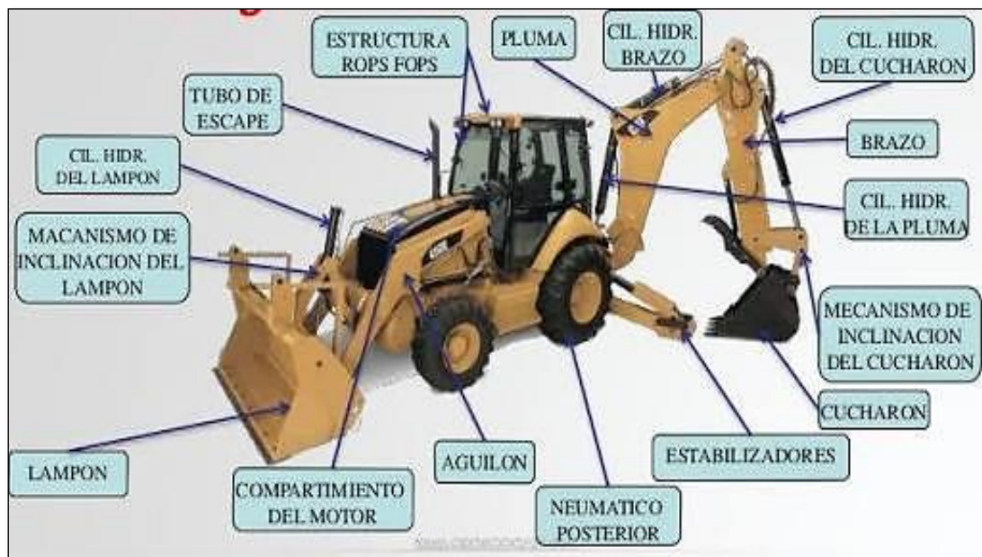
Figura N° 15: Partes de una retroexcavadora Cat 420F
