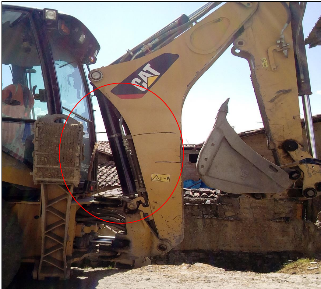
Foto N° 08: Falla en el brazo de la cuchara Fuente: El autor
