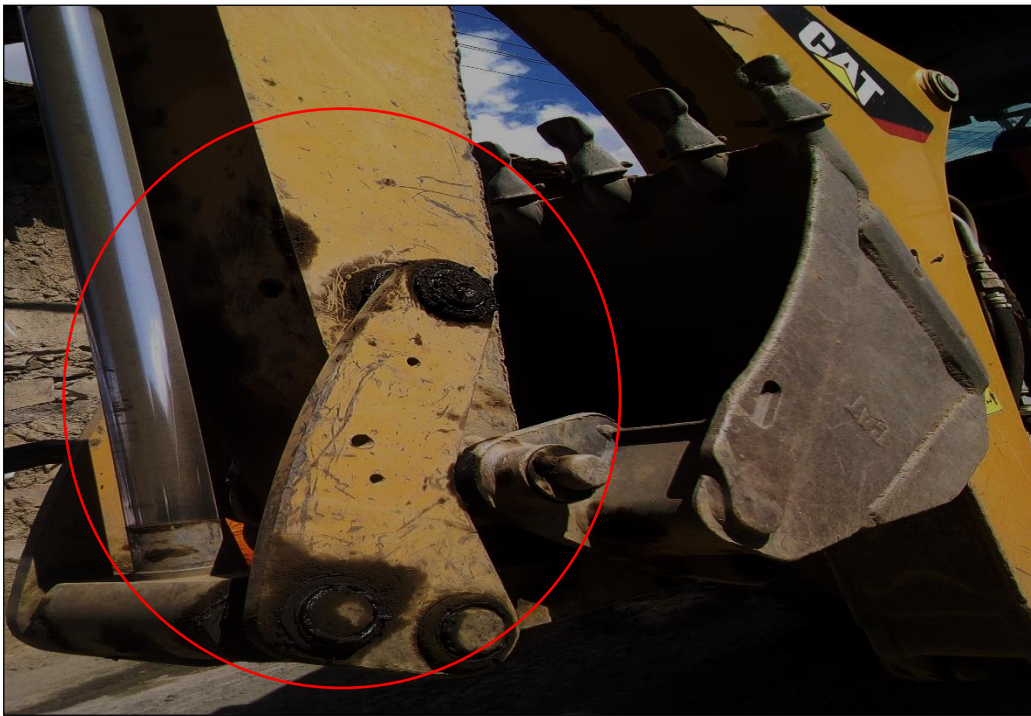
Foto N° 06: Falla en sistema hidráulico Fuente: El autor
