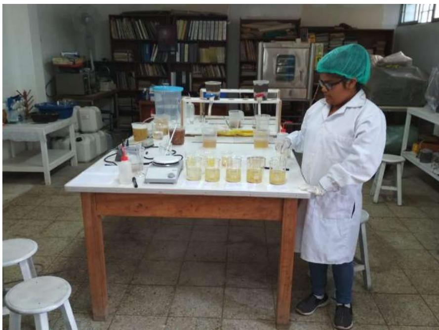
**Figura N° 49: Pruebas iniciales- coagulante sin yodo**
