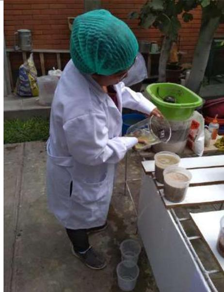
**Figura N° 35: Filtro final para separación de lodos generados**
