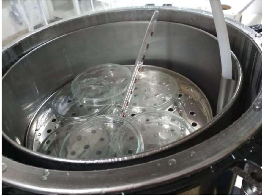
**Figura N° 44: Desinfección de materiales en el autoclave**
