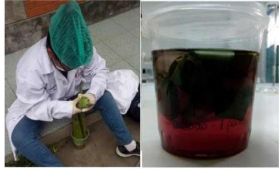
**Figura N° 14: Retiro de dermis y remojo de penca en agua destilada**
