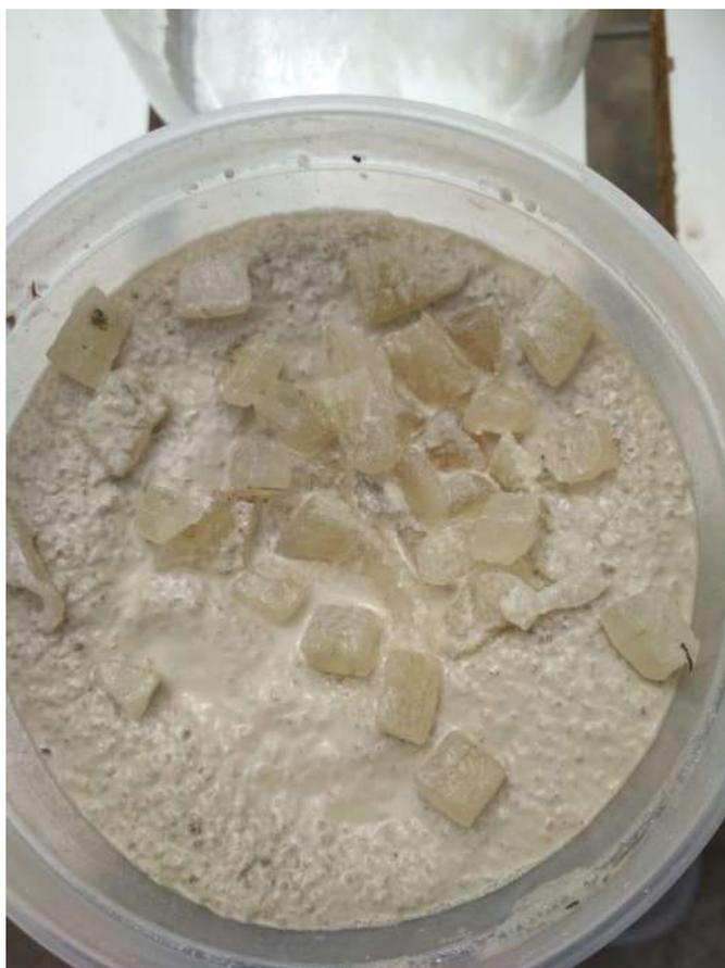
**Figura N° 56: Lodo generado por tratamiento de agua**
