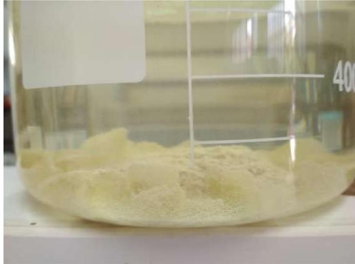
**Figura N° 50: Agua luego de aplicación de coagulante Sy**
