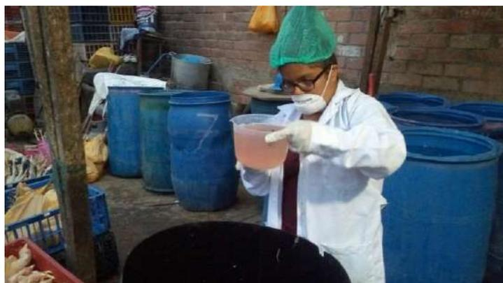
**Figura N° 7: Toma de muestra de afluente**
