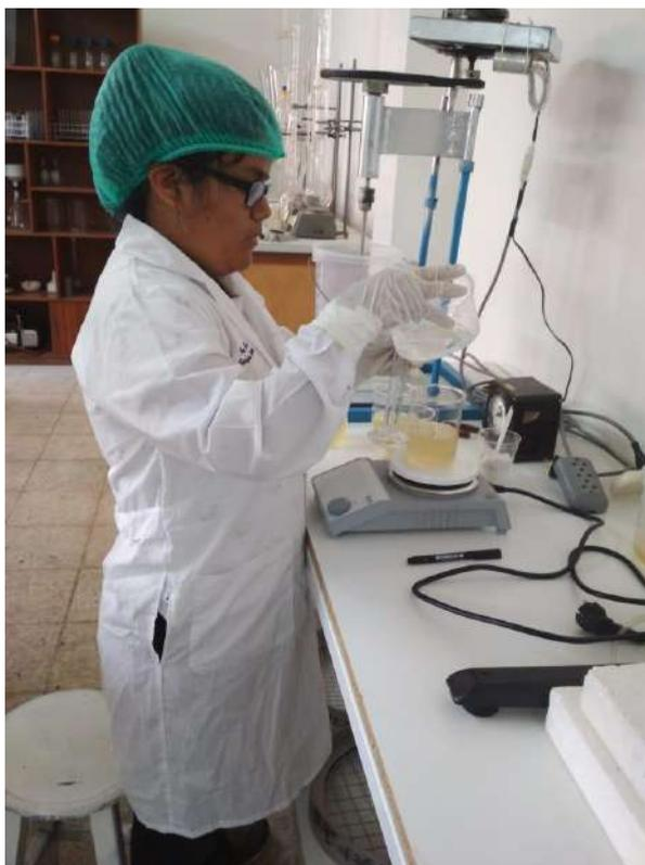
**Figura N° 48: Aplicación de coagulantes en muestras**
