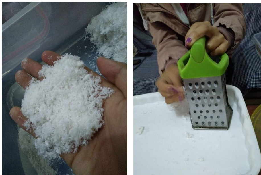
Figura N° 54: Reducción de partículas del quitosano natural con artículos de casa
