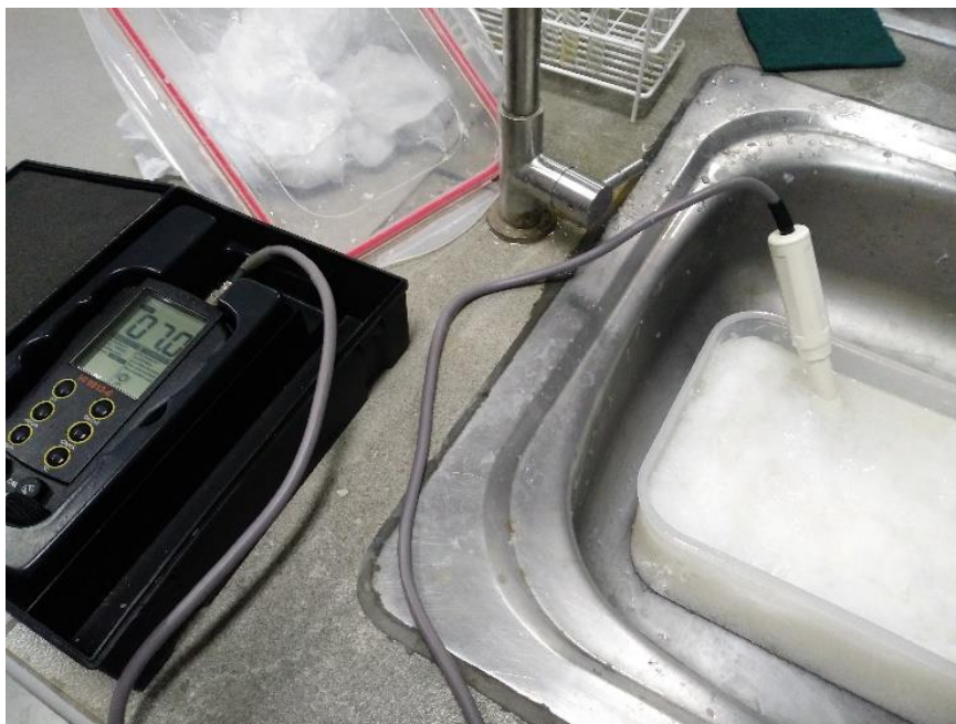
Figura N° 52: Enjuague de la quitina obtenida de plumas de pota y medicion de pH
