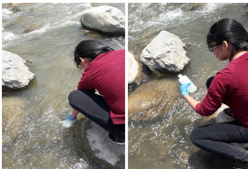
Figura N° 16: Recolección de agua en botellas PVC (500 ml y 1 lt)
