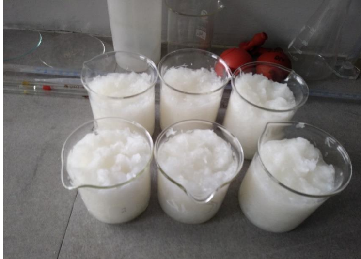
Figura N° 45: Plumas de pota en vasos precipitados antes de entrar a estufa
