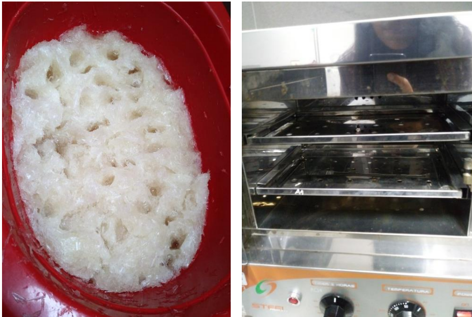
Figura N° 49: Preparación del NaOH en las plumas de pota antes de usar la estufa
