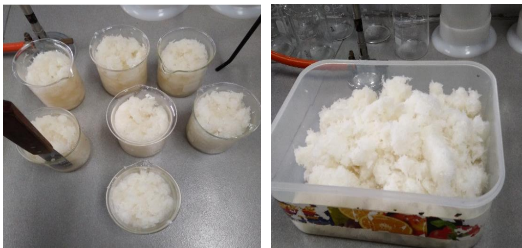
Figura N° 50: Quitina obtenida después del calentamiento en estufa
