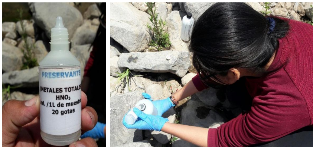
Figura N° 17: Preservación con HNO 3 en botella de 1 lt.
