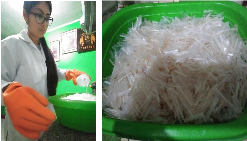
Figura N° 35: Dispersión de la solución en as plumas de pota
