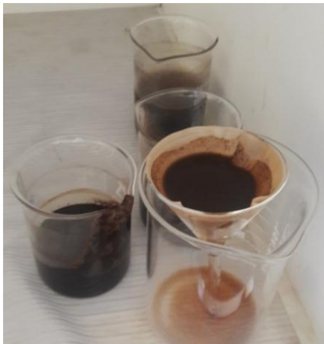
Figura 9: Filtrado de la borra de café luego del lavado con NaOH 0.1 N.
