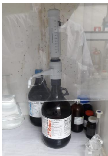
Figura 16: Ácido nítrico con dispensador en campana extractora, utilizado para digestión de muestras.
