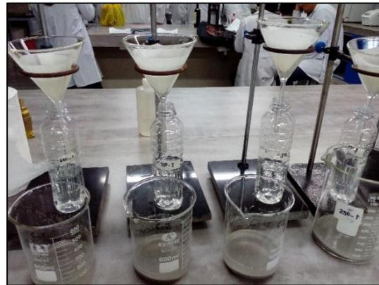
Filtración del adsorbente
