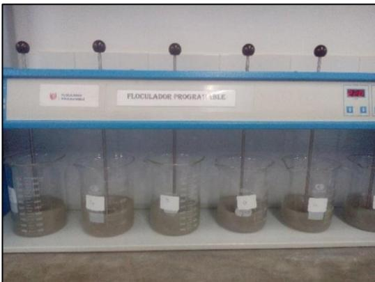
Homogenización del adsorbente-adsorbato
