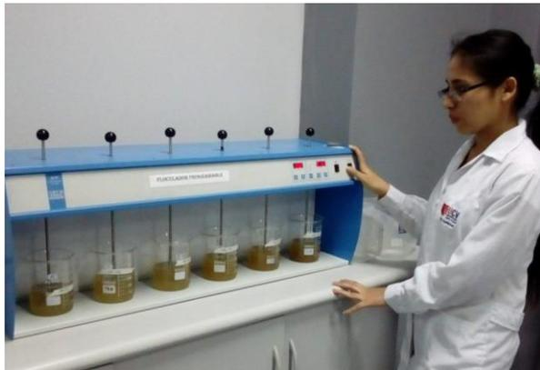
Ensayo de biosorción de Plomo con las diferentes dosis del bioadsorbente en 250mL de la solución preparada. Se agitó a 150 rpm durante 2h a una temperatura de 20°C.
