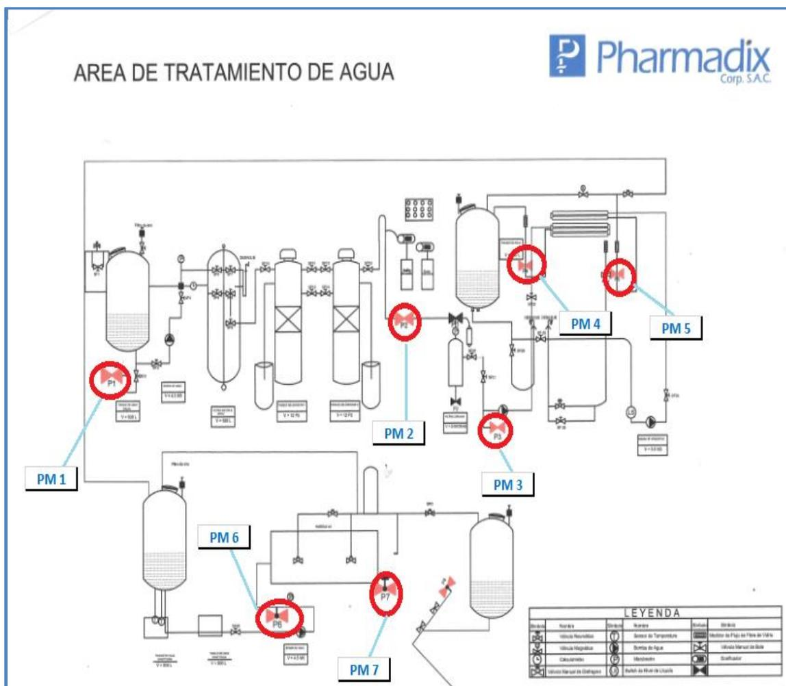
Figura 9. Puntos de muestreo del sistema de agua purificada
