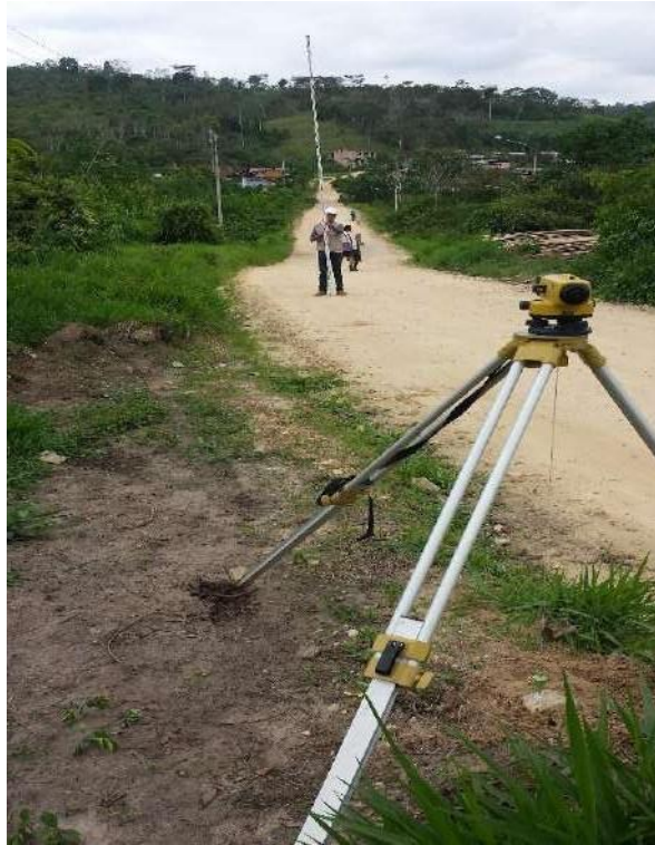
FOTO 05: UBICACIÓN DE LA MIRA EN LOS PRIMEROS 5M APARTIR DEL SEGUNDO PUNTO.
