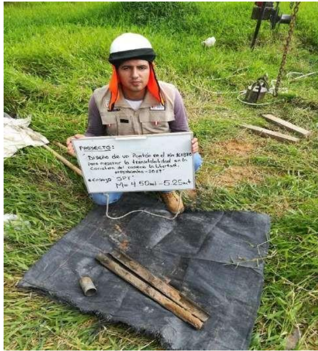
Muestras extraídas mediante la penetración del tubo, hasta 5.25m.
