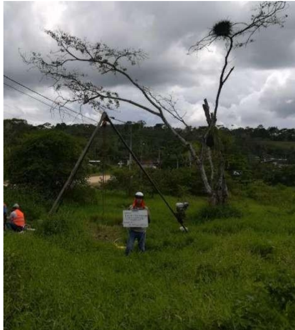
Vista general del ensayo SPT (preparación y armado de los equipos)
