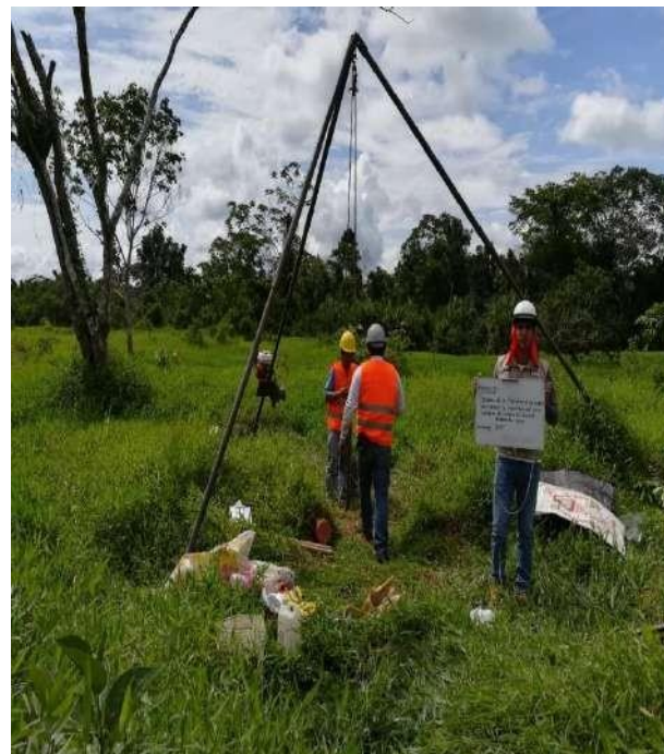
Vista general del ensayo SPT (preparación y armado de los equipos)
