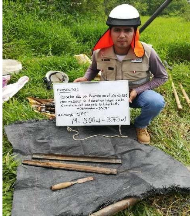
Muestras extraídas mediante la penetración del tubo, hasta 3.75m.
