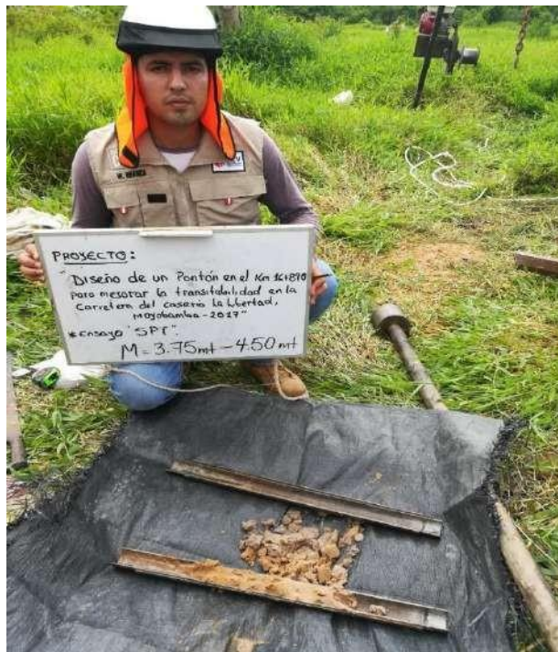
Muestras extraídas mediante la penetración del tubo, hasta 4.50m.
