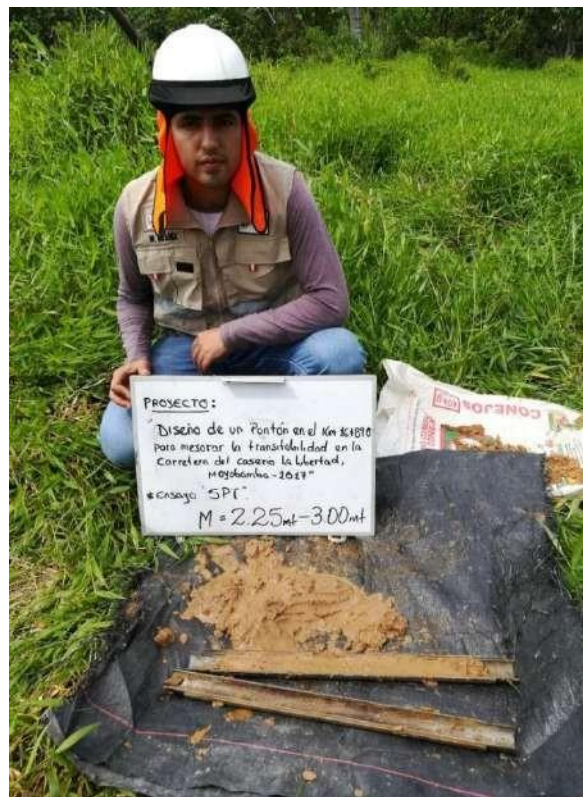
Muestras extraídas mediante la penetración del tubo, hasta 3.00m.
