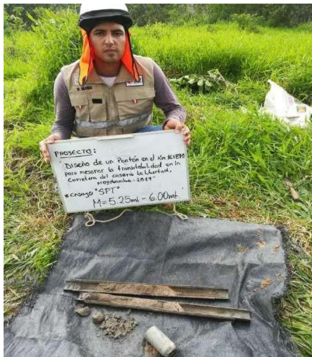
Muestras extraídas mediante la penetración del tubo, hasta 6.00m.
