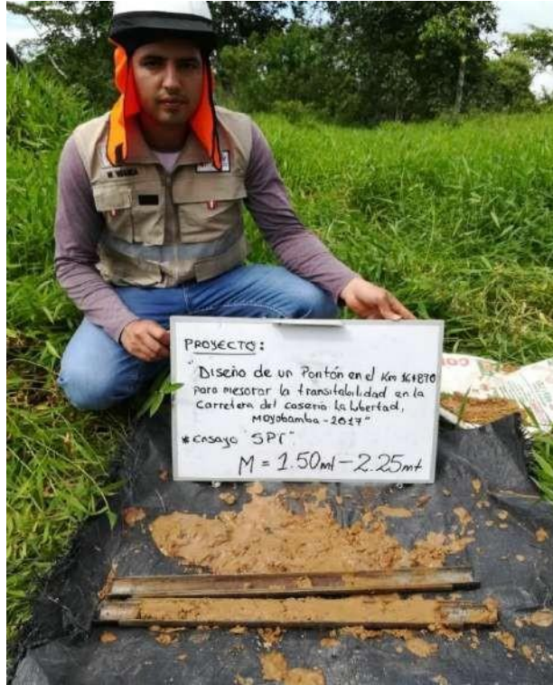
Muestras extraídas mediante la penetración del tubo, hasta 2.25m.
