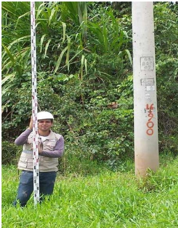
FOTO 06: TOMANDO LECTURA A LOS LADOS DE LA VIA, PARA CONOCER EL NIVEL AL CUAAL LLEGAA EL AGUA EN SUS AVENIDAS MÁXIMAS.
