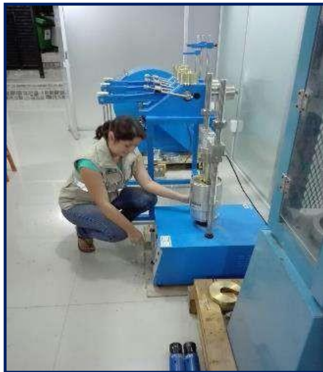
Imagen 10: Se puede observar la muestra de suelo en la máquina de CBR, para realizar la penetración
