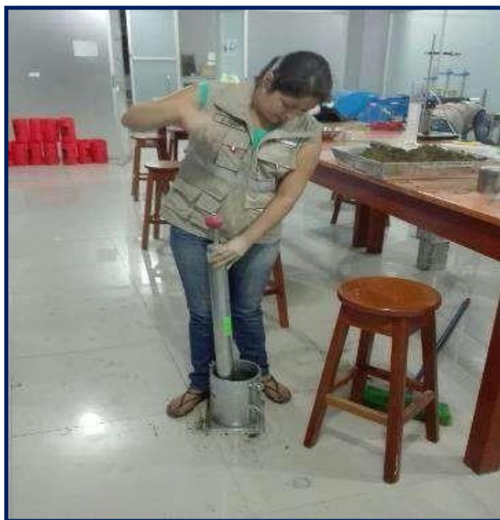
Imagen 8: Se puede observar la realización del ensayo de CBR.
