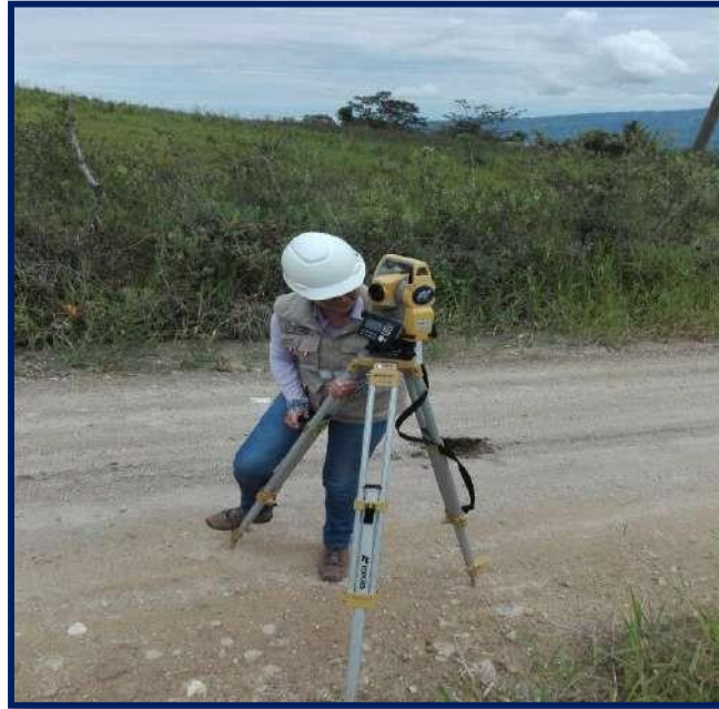
Imagen 1: se puede observar la nivelación de la estación.
