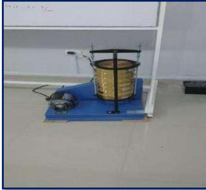
Imagen 3: Se puede observar el tamizado de la muestra lavada y secada.
