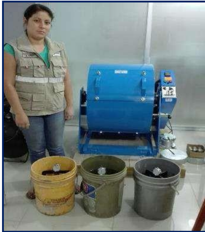
Imagen 9: Se puede observar las muestras del ensayo de CBR sumergidas en agua.
