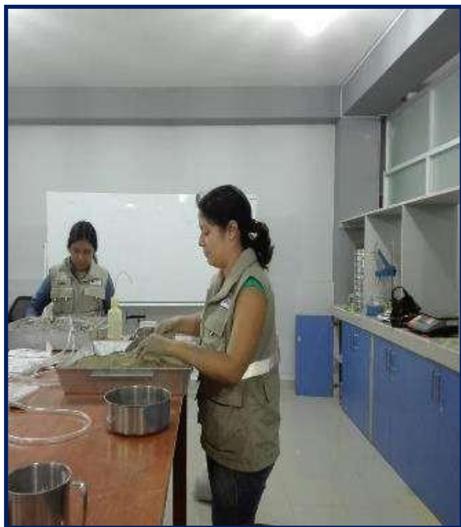
Imagen 7: Se puede observar el mezclado de suelo, cemento portland y ceniza de cáscara de arroz.
