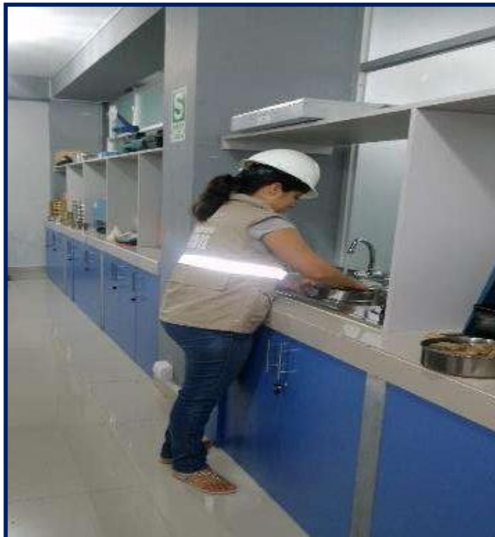
Imagen 2: Se puede observar el lavado de la muestra seca.
