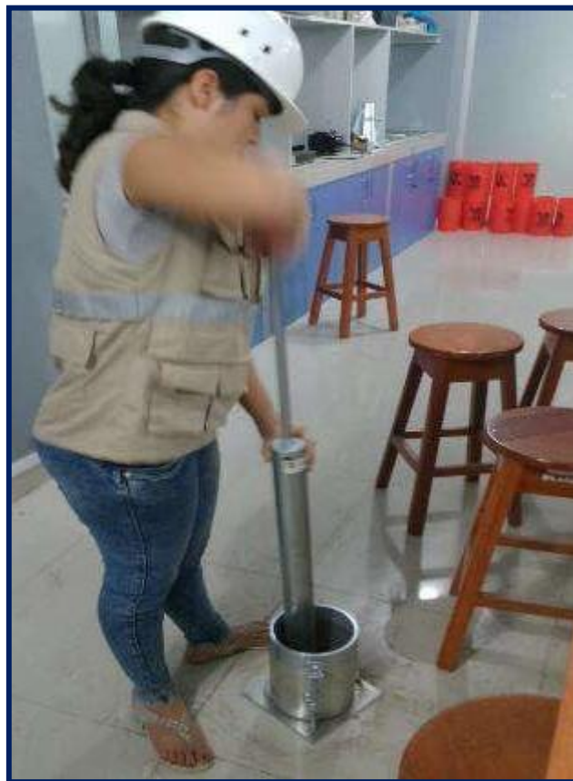
Imagen 6: Se puede observar la realización del ensayo de proctor modificado.
