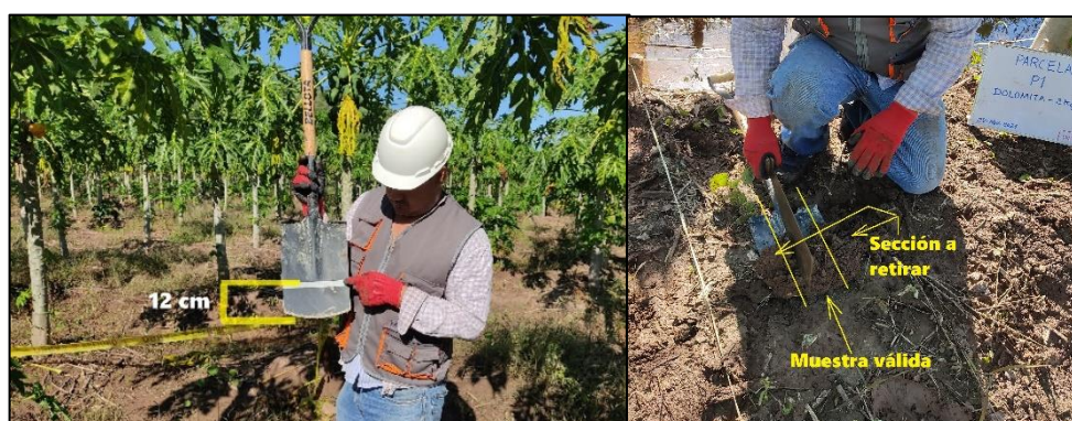
Figura 18: Marcado y extracción de la muestra válida en la parcela P1.
