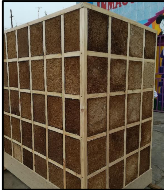
Figura N° 13: Barreras acústica diseñada para la investigación
