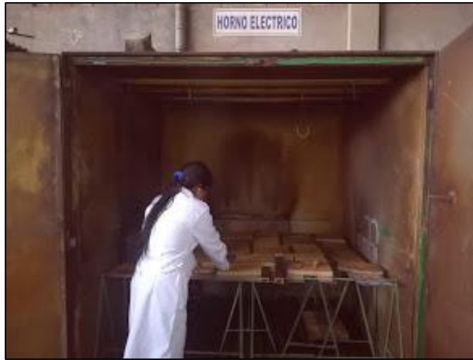
Fotografía N° 7: Colocación de los moldes en el horno eléctrico a 130° C por 26 horas.
