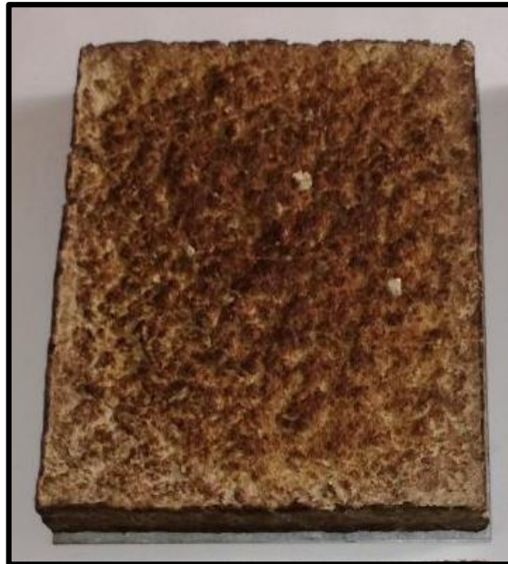
Figura N° 8: Prototipo de Barrera acústica a base de Cáscara de papa y Marlo de choclo
