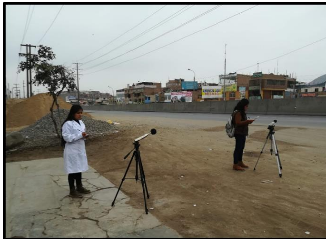
Figura N° 17: Pruebas de nivel de ruido antes de la instalación del sistema
