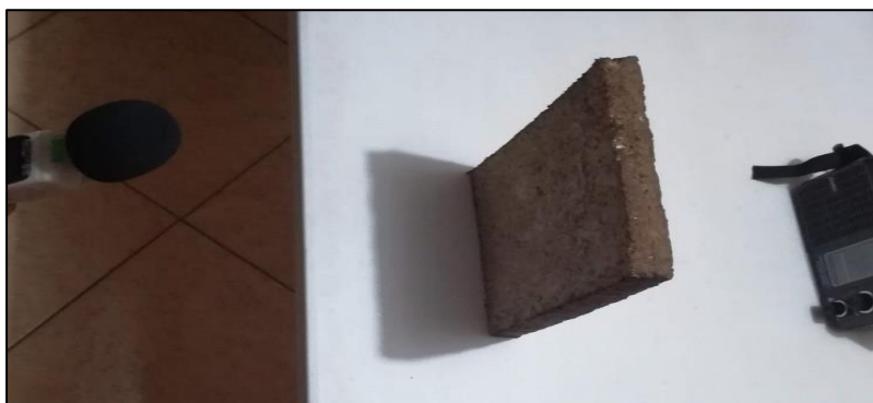
Figura N° 15: Pruebas de nivel de ruido con prototipos de barreras acústicas
