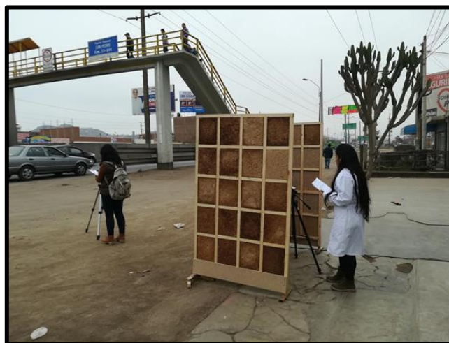
Figura N° 18: Pruebas de nivel de ruido después de la instalación del sistema
