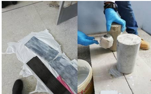
Figura N° 25 Aplicación de sikadur a la lámina Fuente: Elaboración propia.
