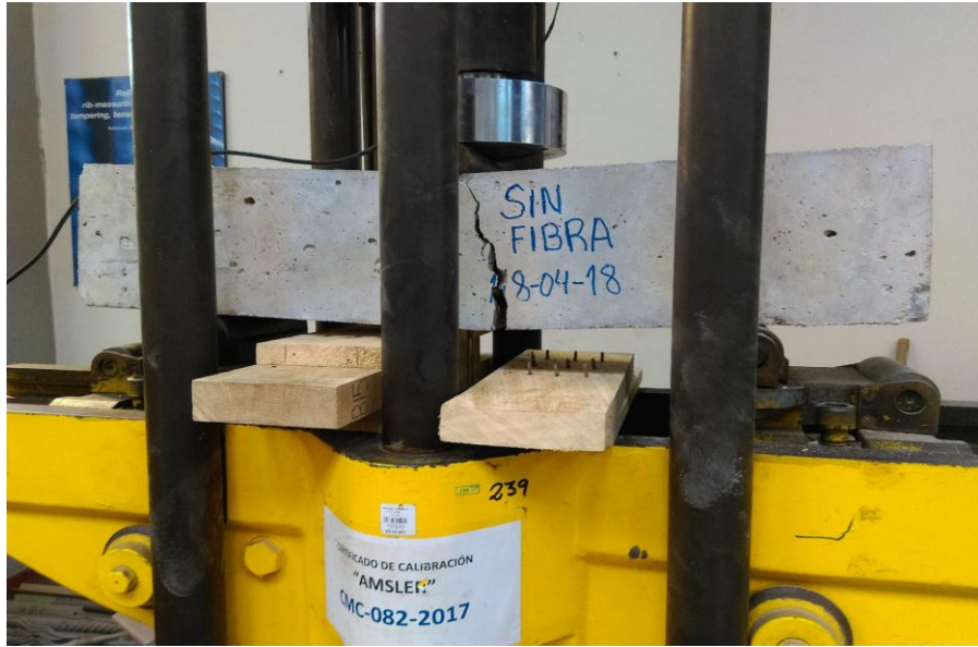
Figura N° 50 Durante el ensayo a flexión la viga se dio una fisura a 90° Fuente: Elaboración propia
