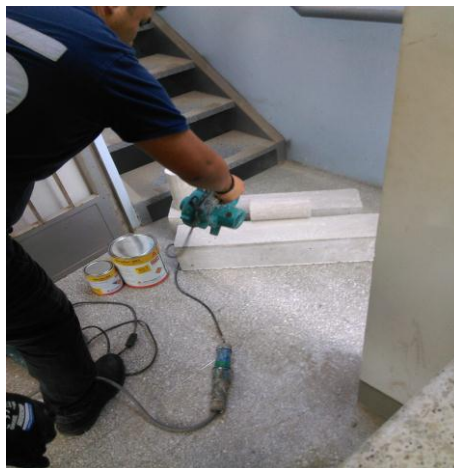
Figura N° 41 Limpieza de probetas con aire a presión Fuente: Elaboración propia.
