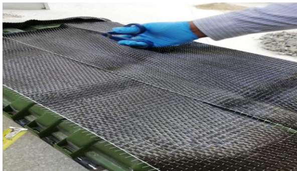
Figura N° 22 Cortado de láminas de fibra de carbono Fuente: elaboración propia.
