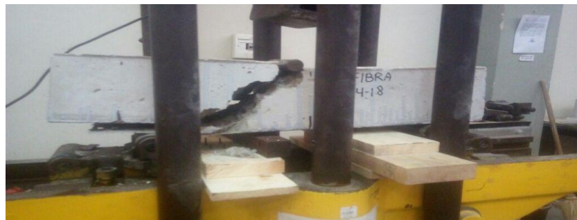
Figura N° 57 Rotura de viga de concreto Fuente: Elaboración propia
