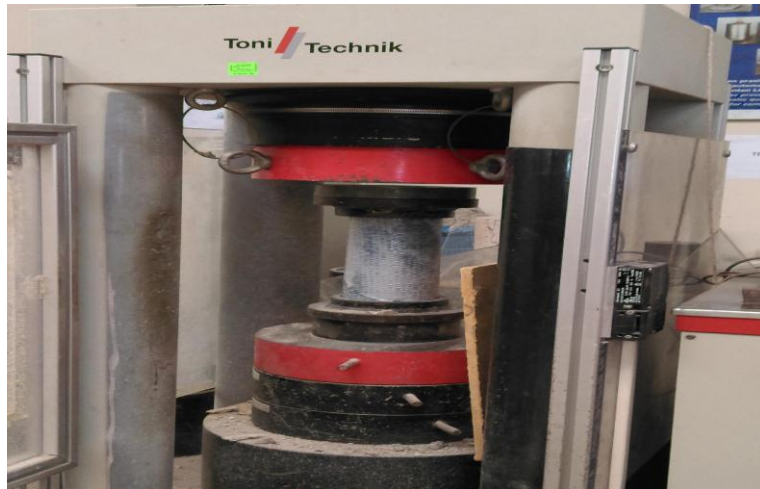
Figura N° 28 Sin lámina de fibra de carbono Fuente: Elaboración propia.
