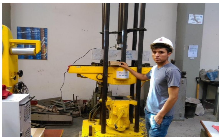
Figura N° 49 Ensayo de viga de concreto sin refuerzo Fuente: Elaboración propia
