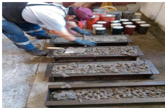
Figura N° 37 Llenado de probetas en dos capas Fuente: Elaboración propia.
