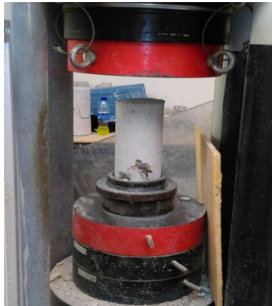
Figura N° 29 Sin lámina de fibra de carbono
