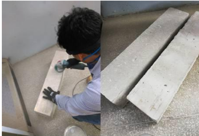
Figura N° 40 Pulido de las vigas probetas Fuente: Elaboración propia.
