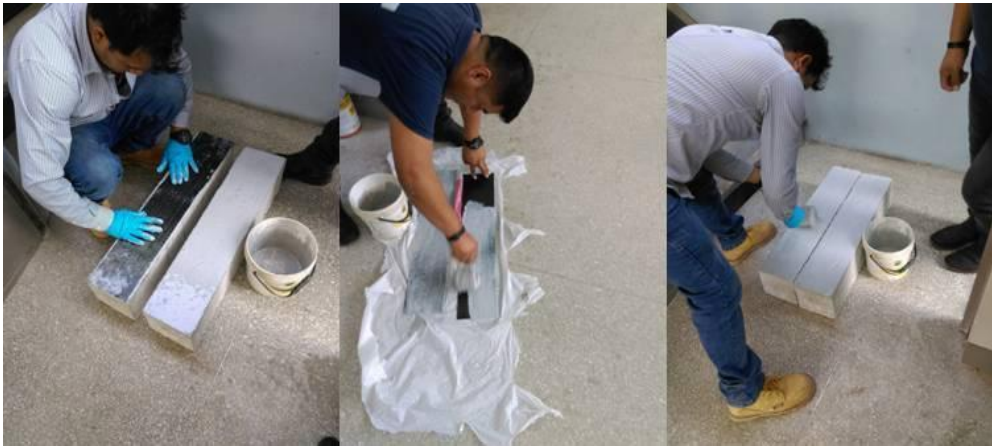
Figura N° 45 Pegado de láminas a las probetas Fuente: Elaboración propia.
