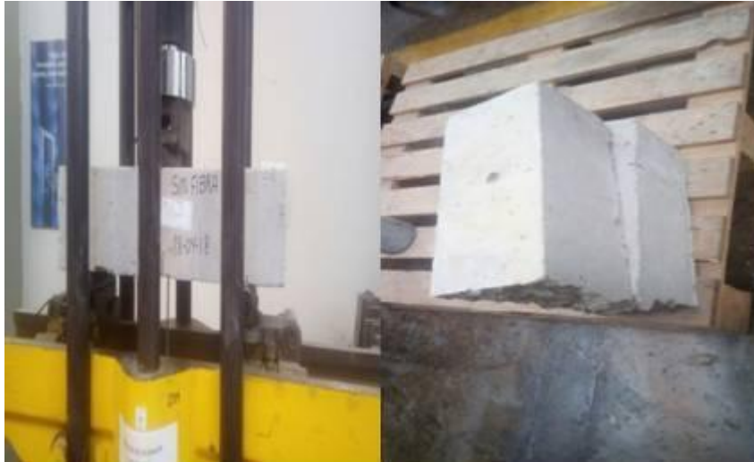
Figura N° 54 Fisura a 90° Fuente: Elaboración propia.
