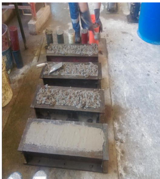
Figura N° 16 Llenando las probetas por capas Fuente: Elaboración propia
