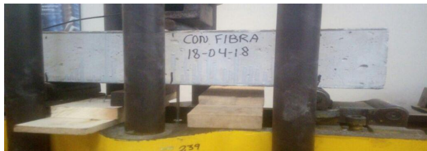
Figura N° 56 Ensayo de viga de concreto con fibra Fuente: Elaboración propia
