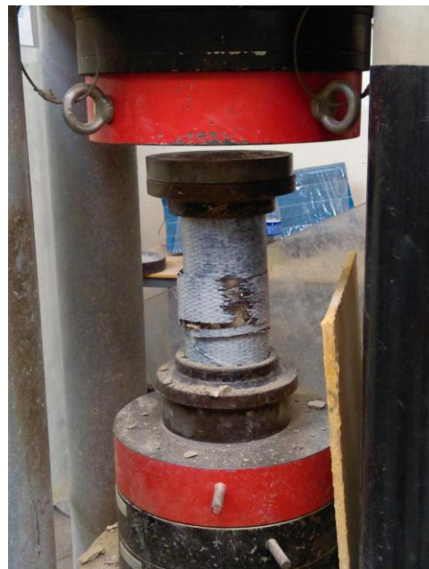
Figura N° 30 Con lámina de fibra de carbono
