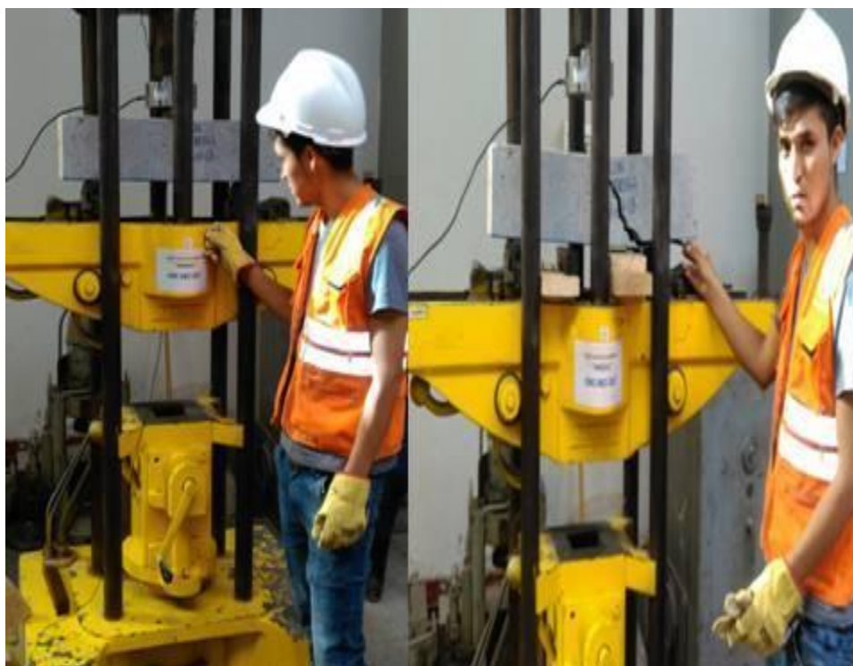
Figura N° 52 Ensayo con refuerzo de lámina de fibra de carbono - 14 días. Fuente: Elaboración propia.
