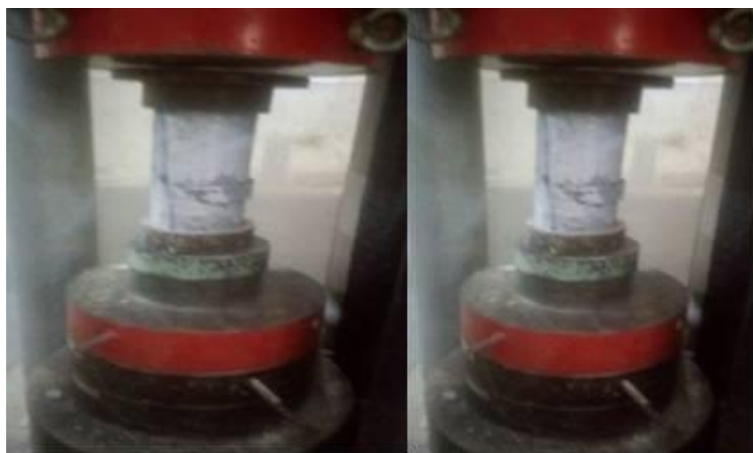
Figura N° 31 Probeta CON lámina y SIN lámina
