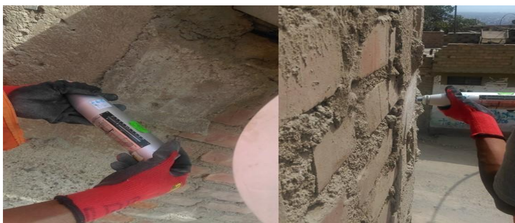
Figura N° 6 Aplicación del Martillo de rebote Fuente: Elaboración Propia
