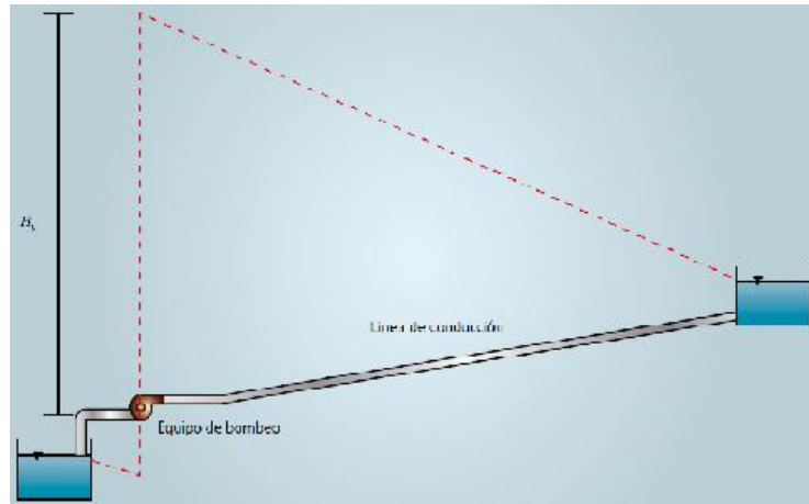
Figura 1.7. Esquema de conducción por bombeo
