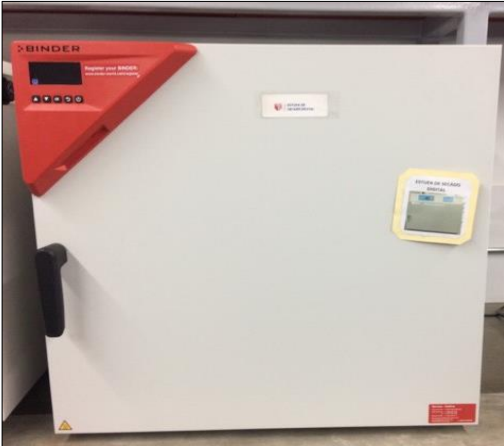
Figura 7 Estufa de alta presión para secado de muestras.
