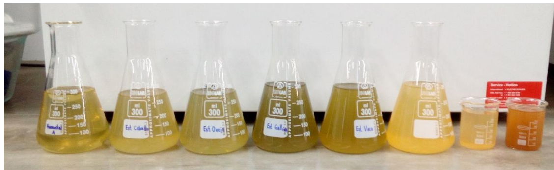
Muestras de cada componente del Sistema de Tratamiento Pasivo “A”
