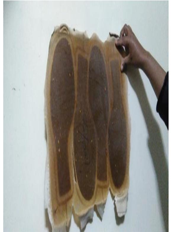
Moldeo por compresión en caliente Caucho en natural después de prensa hidráulica
