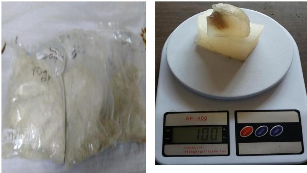
Después de moler la fibra de cabuya se separa cada muestra en una bolsa térmica
