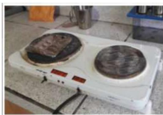
*FIGURA 19.* Pre carbonización de residuos de tela por 24 horas
