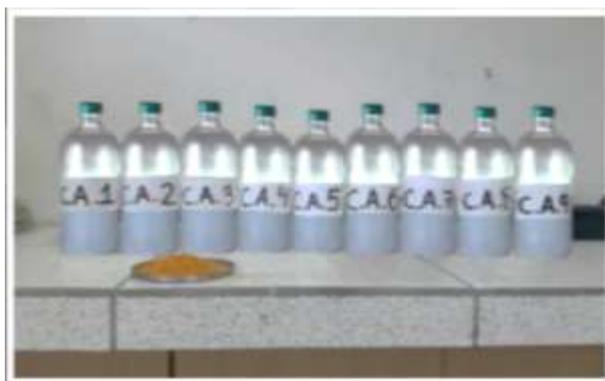
*FIGURA 23.* Carbón activado en botellas serológicas con  $\text{FeCl}_3$
