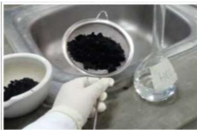
*FIGURA 20.* Lavado de carbones activados con Ácido Clorhídrico al 10%
