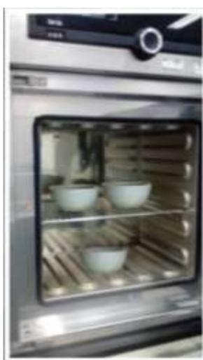
*FIGURA 21.* Carbones activados en el horno
