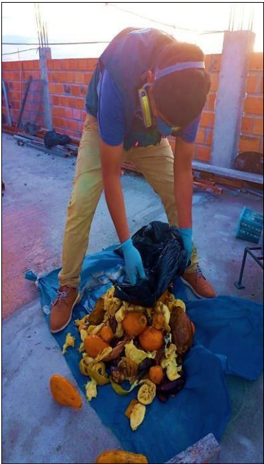
Fotografía 8: Martes 14 de setiembre del 2021, se procedió abrir la bolsa donde contenía los residuos orgánicos papaya, plátano, naranja, caña de azúcar, luego de haber retirado algunos escombros y previamente pesado, para luego depositarlo en el balde de 20L, con agua destilada y estiércol de animal equino, dejando libre un espacio de 6 cm, para facilitar su manejo.
