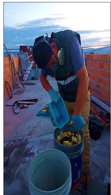
Fotografía 8: Martes 14 de setiembre del 2021, se procedió abrir la bolsa donde contenía los residuos orgánicos papaya, plátano, naranja, caña de azúcar, luego de haber retirado algunos escombros y previamente pesado, para luego depositarlo en el balde de 20L, con agua destilada y estiércol de animal equino, dejando libre un espacio de 6 cm, para facilitar su manejo.
