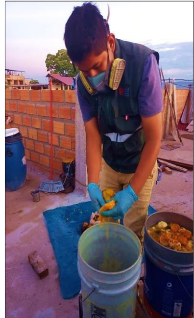
Fotografía 9: Martes 14 de setiembre del 2021, se procedió abrir la bolsa donde contenía los residuos de mango, previamente pesado y retirado algunos escombros, para luego depositarlo en el balde de 20L, con agua destilada y estiércol de animal equino, dejando libre un espacio de 6 cm facilitar su manejo.
