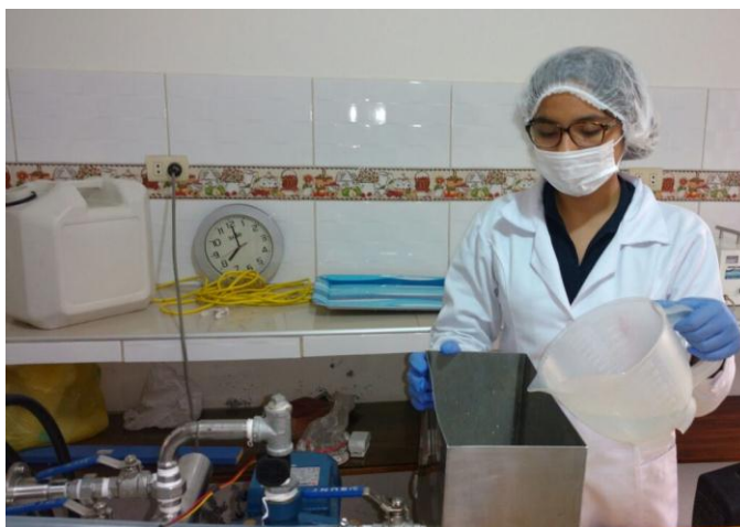
Figura N° 8. Ingreso del agua residual al generador de nanoburbujas
