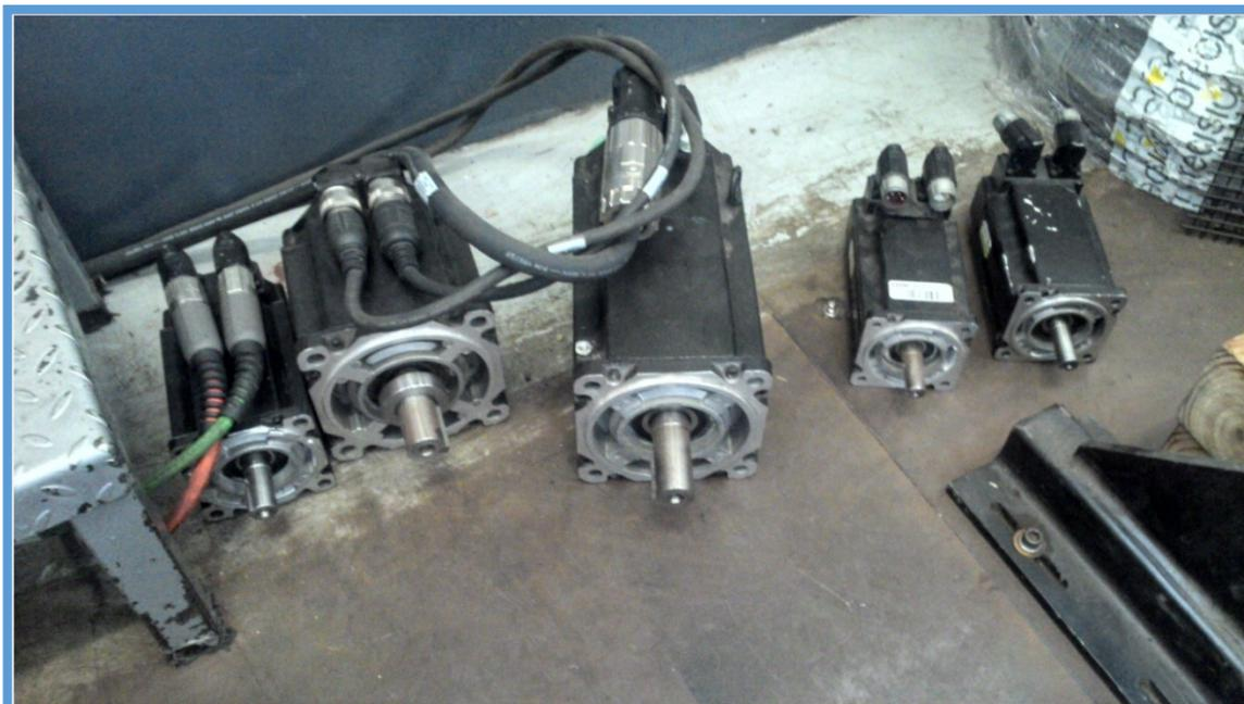
*Figura 55.* Servos motores MPL\*\*\* con propósito de entrenamiento.
