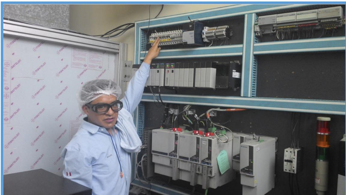
*Figura 54. Tablero sistema de control PLC Rslogix 500 – Servo driver Kinetix 6000, para entrenamiento de técnicos electrónicos.*
