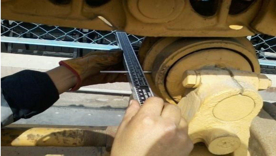
Figura17: Inspección de carrilería
