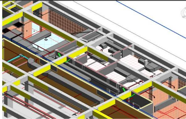
Interferencia de tubería de desagüe con red eléctrica en área de equipos eléctricos entre los ejes a-b/ 3'-4 en sótano 2
