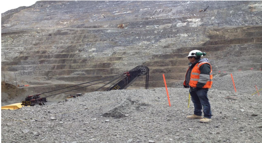
Figura N° 4 Se observa el material calcáreo que servirá para ser procesado como agregados para el núcleo de concreto asfáltico.
