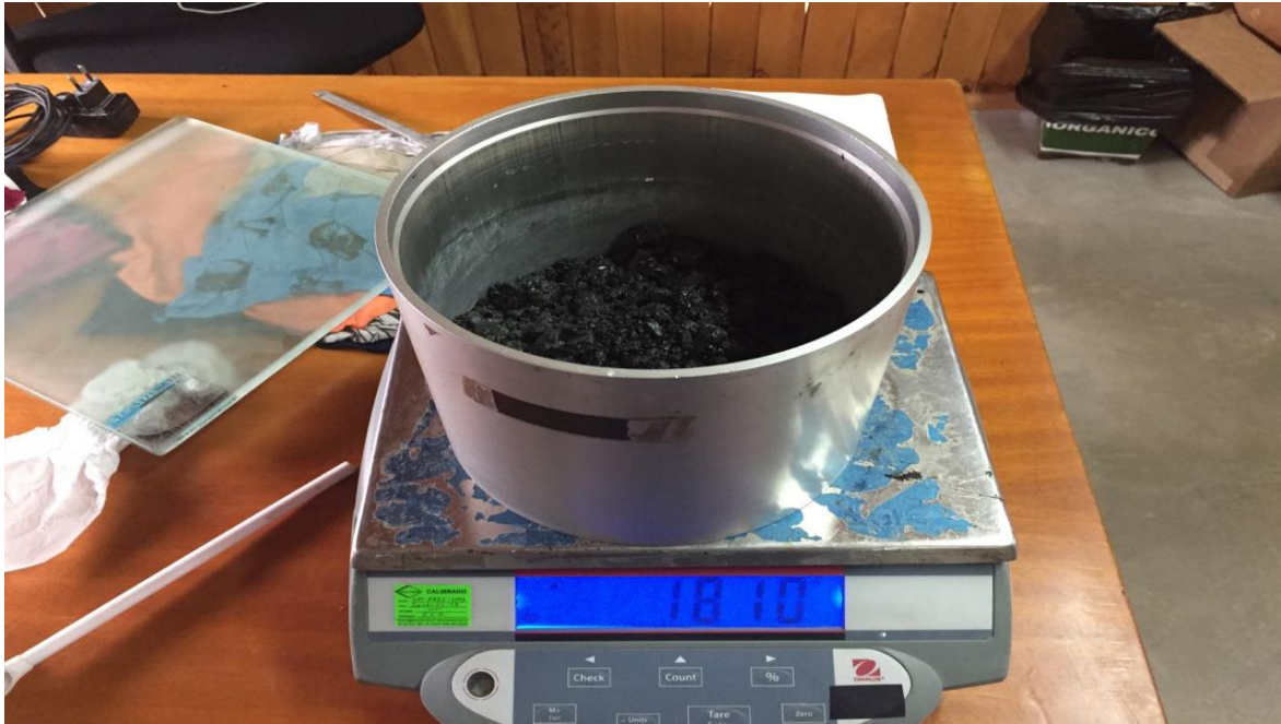
Figura 1111: Pesado de material, mezcla asfáltica para ser sometida al proceso de lavado y determinar el porcentaje de asfalto
