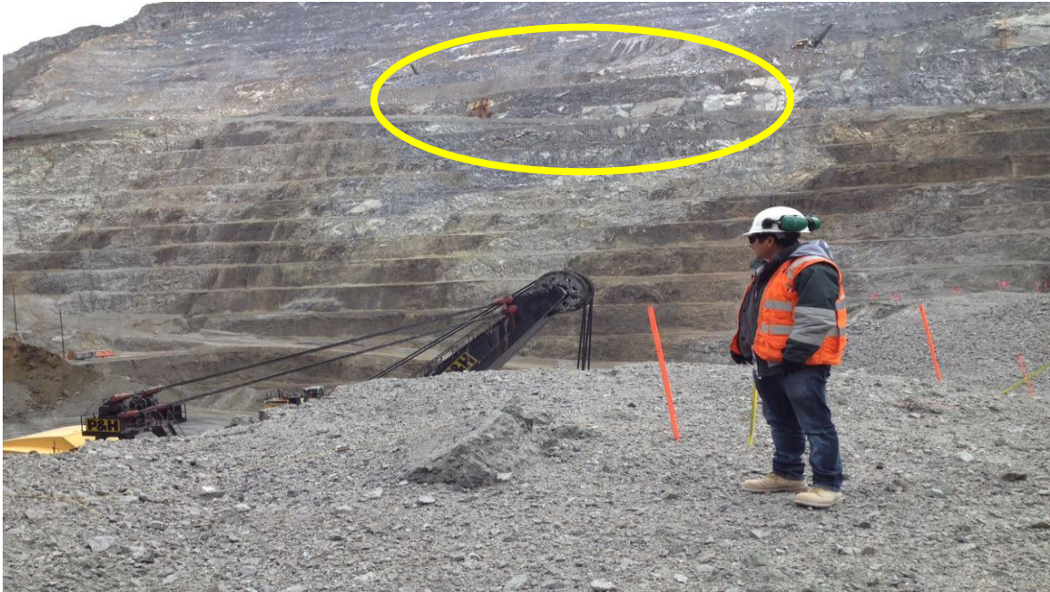
Figura 011: Se observa el material calcáreo que servirá para ser procesado como agregados para el núcleo de concreto asfáltico.
