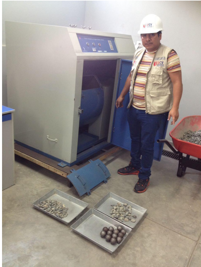
Figura 099: Ensayo de desgaste en la máquina de los Ángeles
