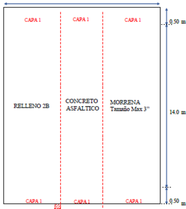
Figura N° 12 Vista en planta de ubicación de las capas, fuente elaboración propia.
