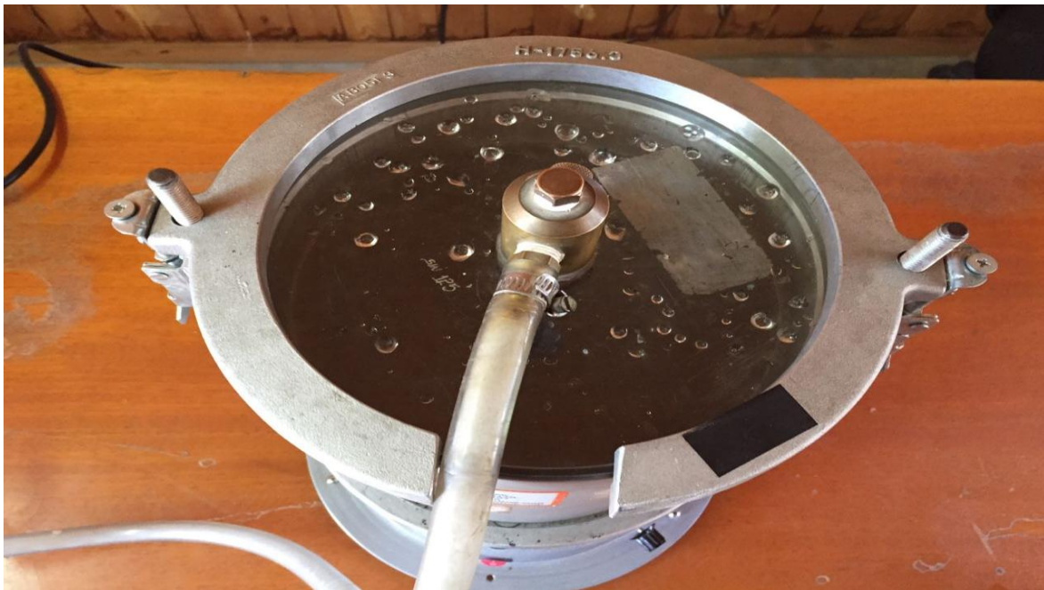
Figura 1010: Ensayo para determinar la máxima densidad de la mezcla asfáltica (Rice)
