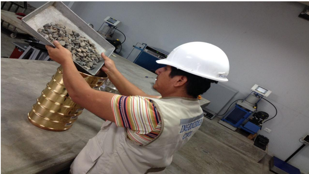
Figura 066: Ensayo de tamizado granulometría por el método del tamizado
