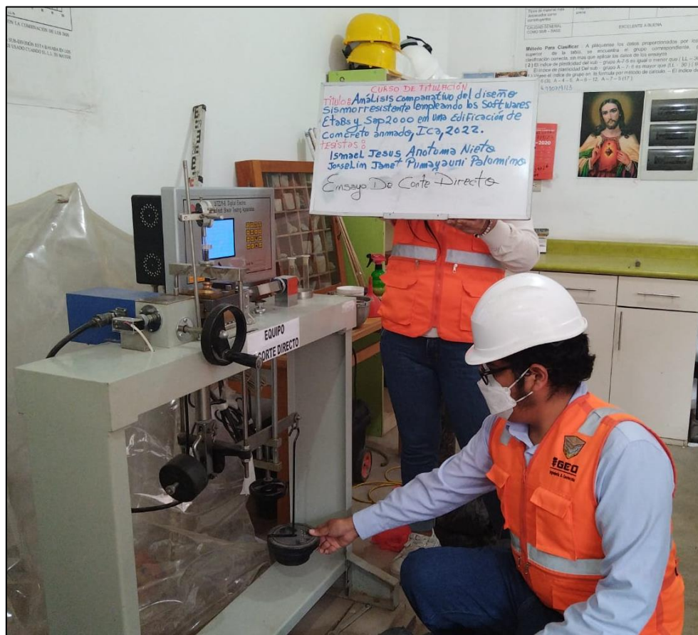
FOTO 16 ENSAYO DE CORTE DIRECTO
