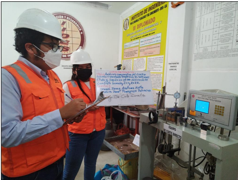
FOTO 14 ENSAYO DE CORTE DIRECTO
