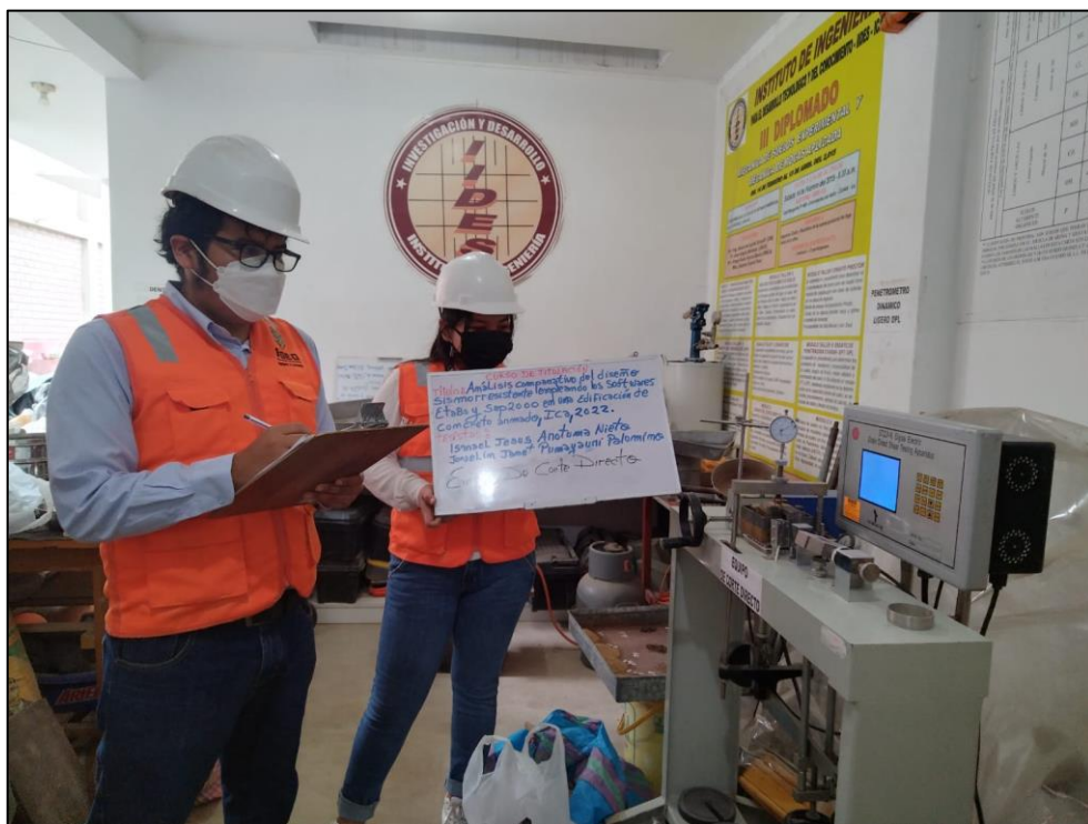
FOTO 14 ENSAYO DE CORTE DIRECTO
