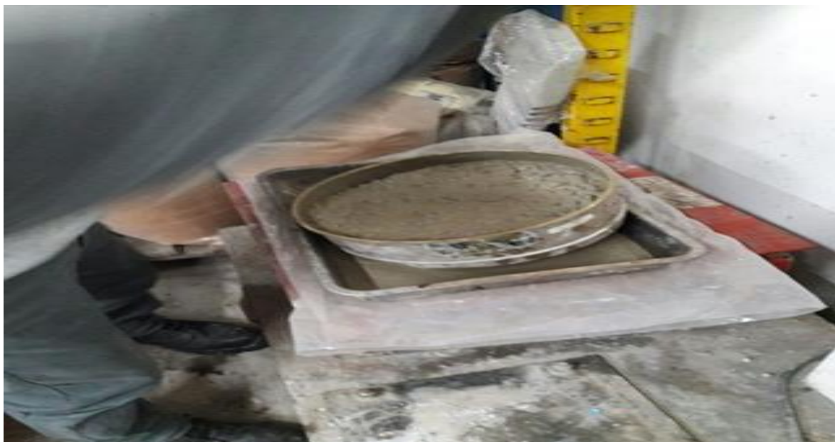
Figura III. 13 Proceso de tamizado del concreto para obtener mortero para ser colocado en el molde metálico para el ensayo de fraguado.
