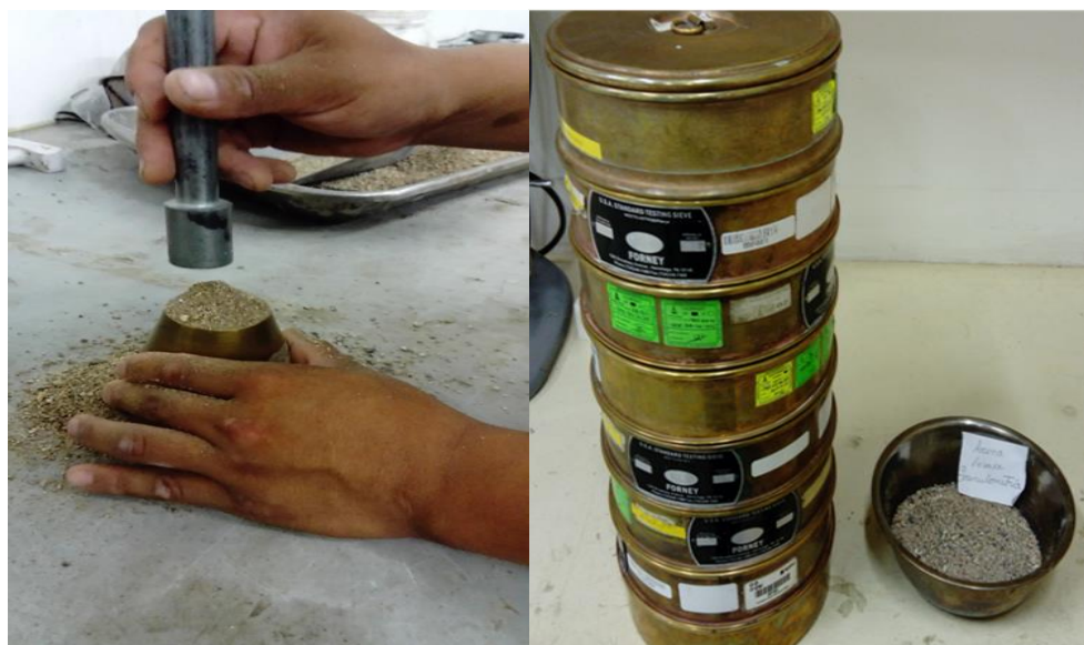
Figura III. 7 Determinando la saturación superficial del agregado fino y la granulometría
