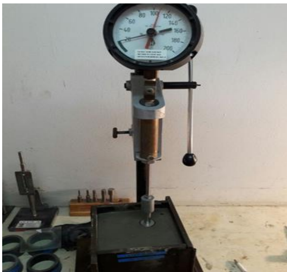
Figura III. 14 Equipo de fraguado en proceso de penetración de las agujas de fraguado para determinar fraguado inicial y final.
