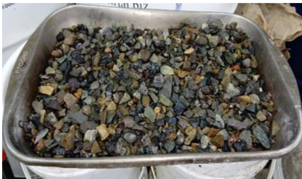
Figura III. 8 Saturación del agregado grueso para determinar su peso específico y absorción.
