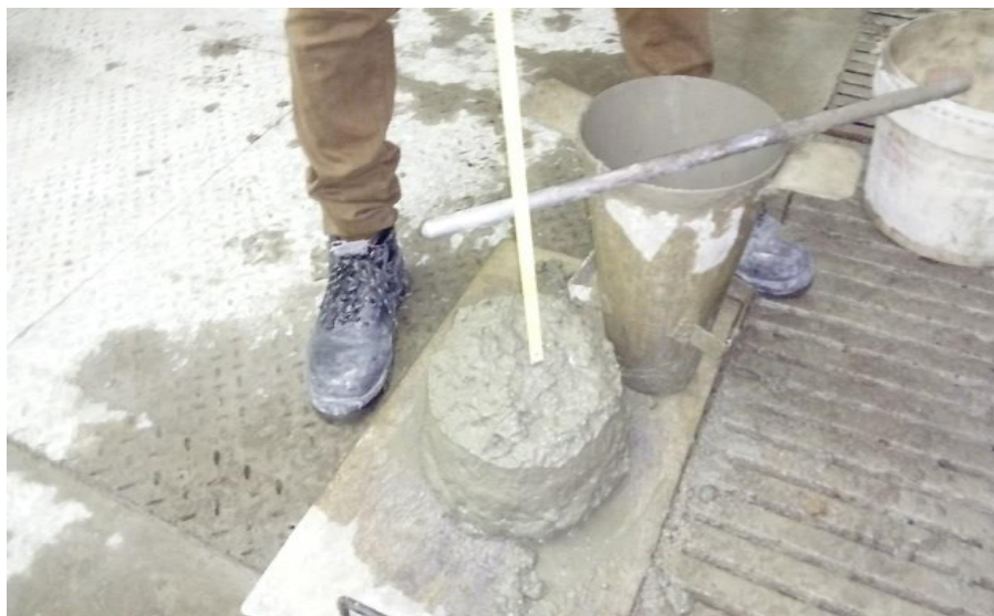
Figura III. 15 Ensayo de Asentamiento del concreto para determinar la consistencia de la mezcla.
