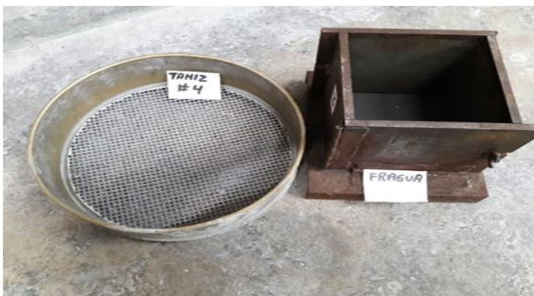
Figura III. 12 Tamiz numero # 4 y molde metálico cuadrado para realizar en ensayo de fraguado.
