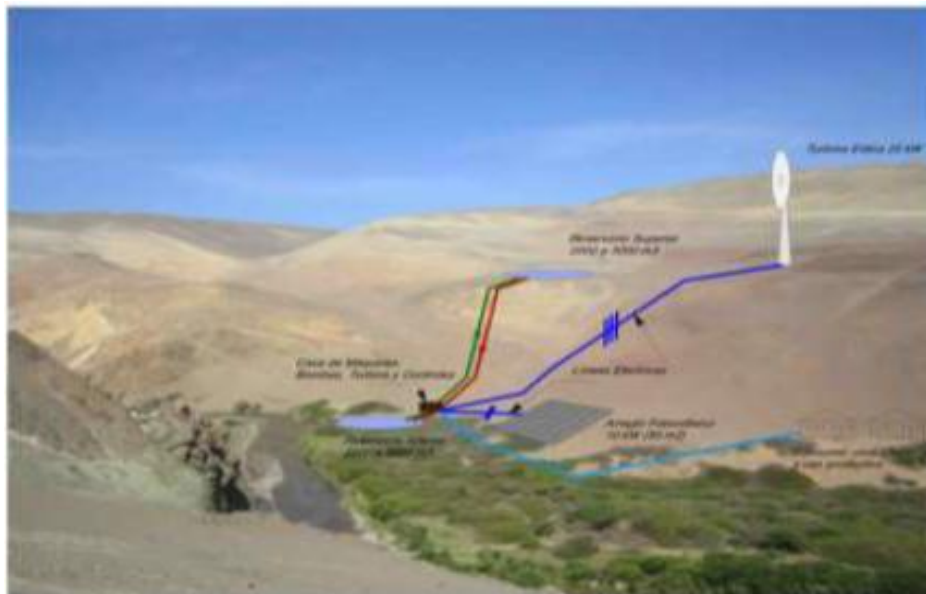
Figura 22: Esquema del sistema Híbrido (20kw eólico ,10kwsolar) con almacenamiento de energía por medio del agua bombeada (ubicación Hipotética en Nazca)
