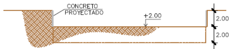
IMAGEN 3. 8 Sección transversal anillo 01
