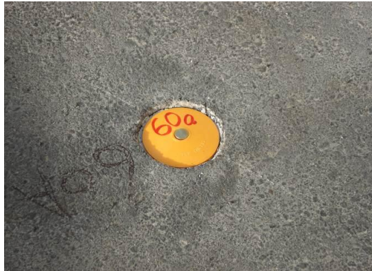
IMAGEN 4. 12 Punto de asientos en pavimento instalado
