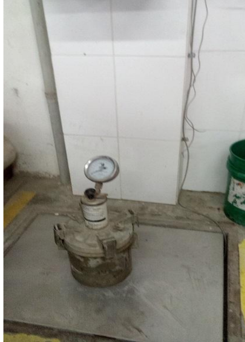
Figura III, 10: Ensayo para determinar peso unitario Fuente: Elaboración propia
