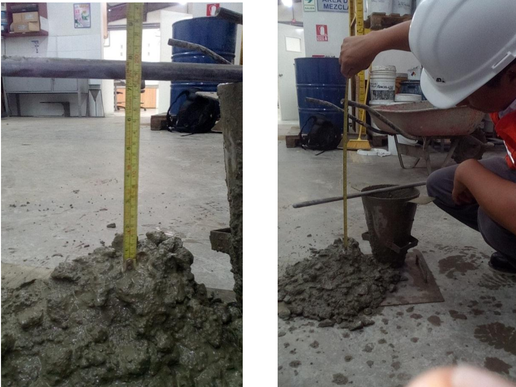
Figura III, 7: Ensayo de asentamiento mediante el Cono de Abrams Fuente: Elaboración propia
