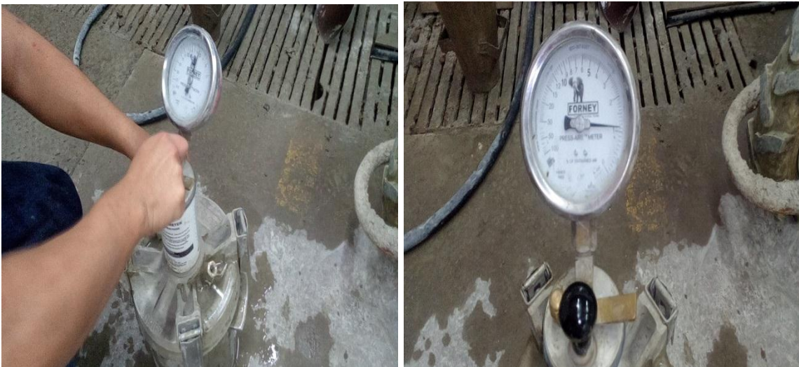
Figura III, 9: Ensayo para determinar el Aire atrapado en el concreto Fuente: Elaboración propia
