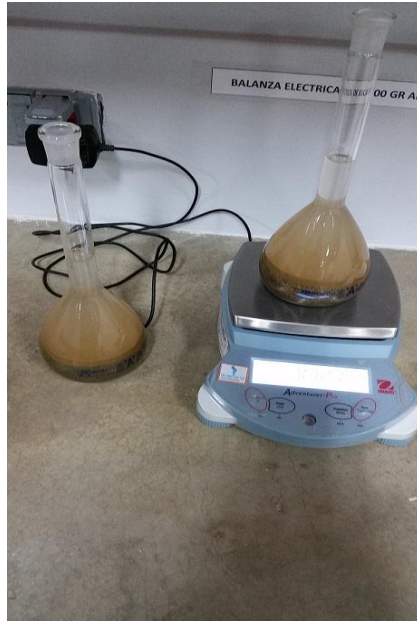
Paso 3: Llenar en la probeta y medir el volumen desplazado.
