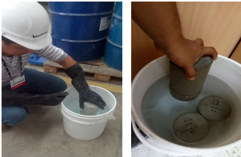
Figura III, 12: Inmersión de la muestra en agua a temperatura de 21°C por 48 hrs. Luego se procede al secado y pesaje de la muestra. Fuente: Elaboración propia.
