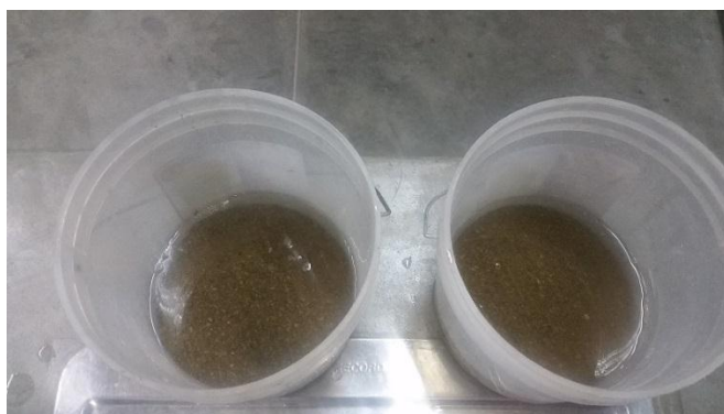
Paso 1: Remojar 5Kg de muestra durante 24 hrs.
