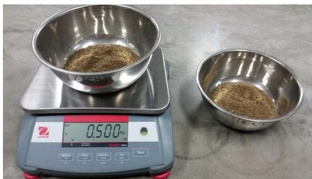
Paso 2: Secar a temperatura ambiente y pesar la muestra.
