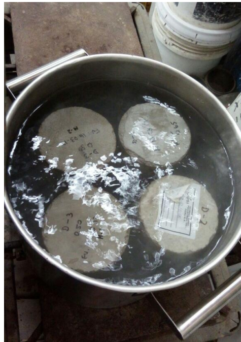
Figura III, 13: Inmersión y hervido de la muestra en agua durante 5 hrs. Luego se procede al secado natural y pesaje de la muestra. Fuente: Elaboración propia.
