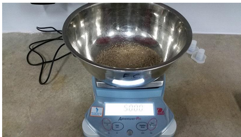
Paso 5: Pesar la muestra y calcular el peso específico y absorción.
