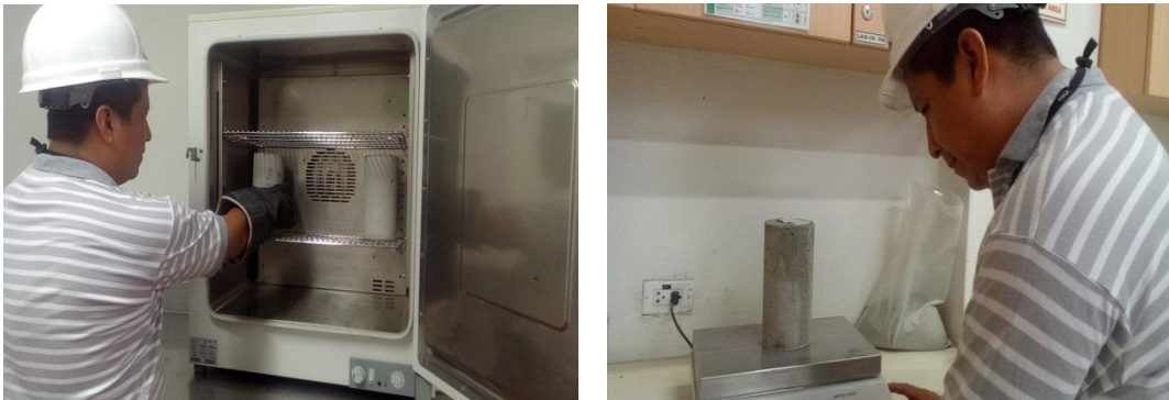
Figura III, 11: Secado en horno de la muestra a 100°C durante 24 hrs. y determinación del peso seco. Fuente: Elaboración propia.
