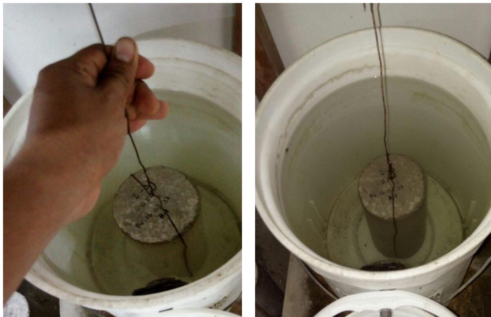
Figura III, 14: Determinación de peso aparente en muestra sumergida. Fuente: Elaboración propia.
