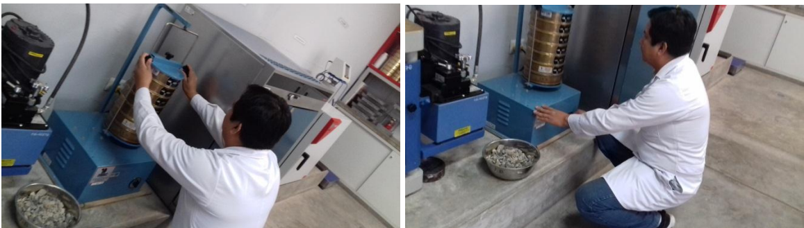
Figura III, 6: Ensayo granulométrico de piedra y arena Fuente: Elaboración propia
