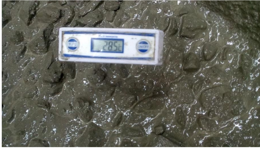
Figura III, 8: Ensayo para determinar la temperatura del concreto. Fuente: Elaboración propia
