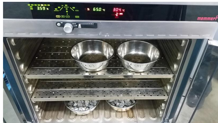
Paso 4: Llevar la muestra al horno durante 24 hrs.
