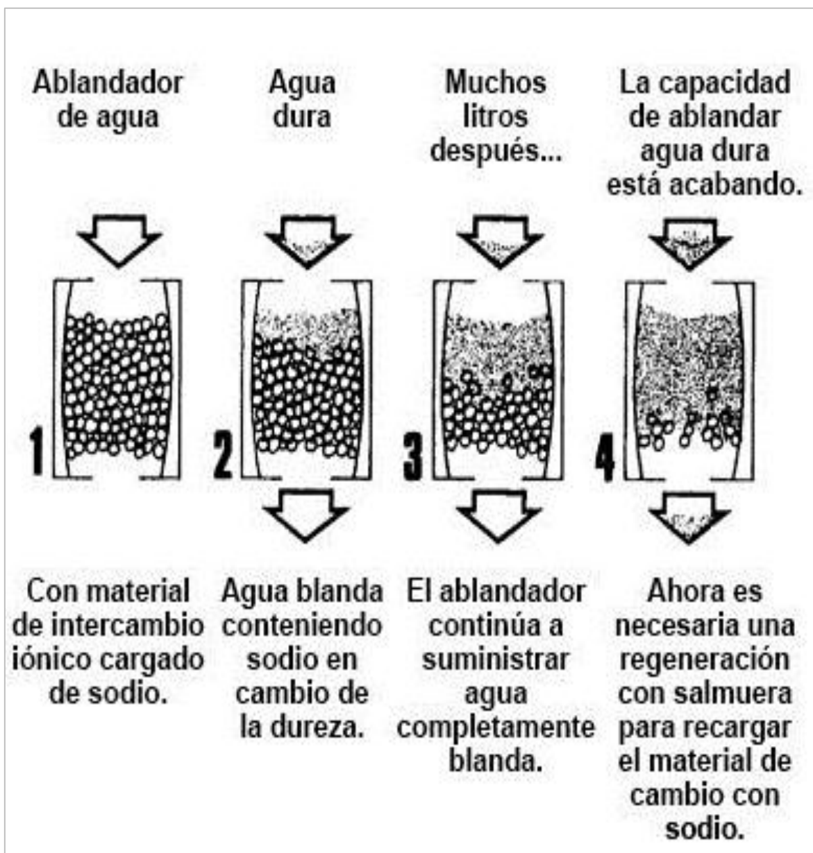
Figura 17: Ciclo de ablandamiento del agua
