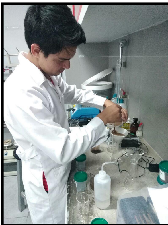
Anexo 11. Filtrado del suelo con agua destilada
