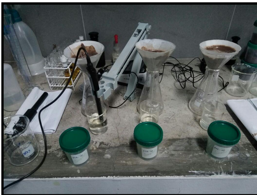
Anexo 11. Filtrado del suelo con agua destilada
