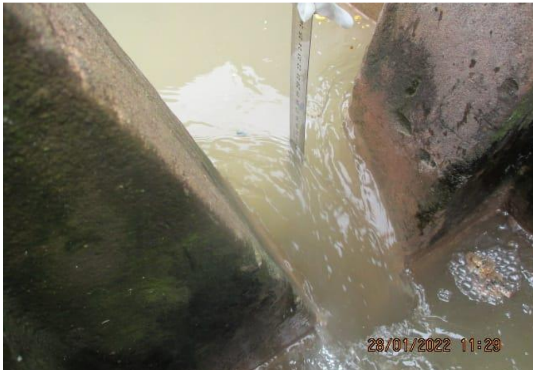
Figura 09 Medición de la altura del agua del vertedero triangular.
