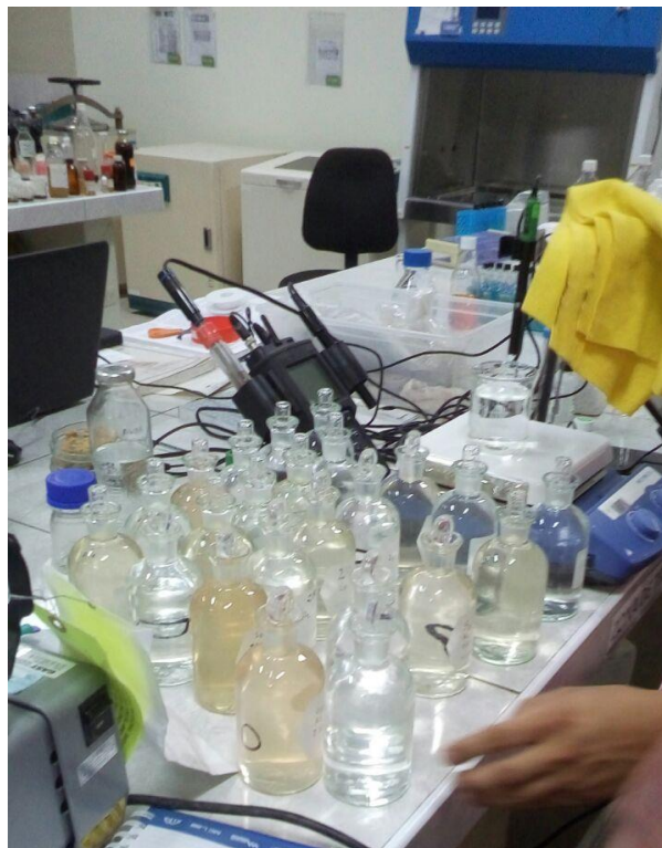
ILUSTRACIÓN Nº 21: ANÁLISIS DE LA DEMANDA BIOQUÍMICA DE OXIGENO POR EL MÉTODO CONVENCIONAL
