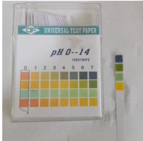
ILUSTRACIÓN N° 11: EL PH ES 7 DE LA MUESTRA DEL EFLUENTE CAMAL MUNICIPAL EL PORVENIR CON PAPEL INDICADOR DE PH
