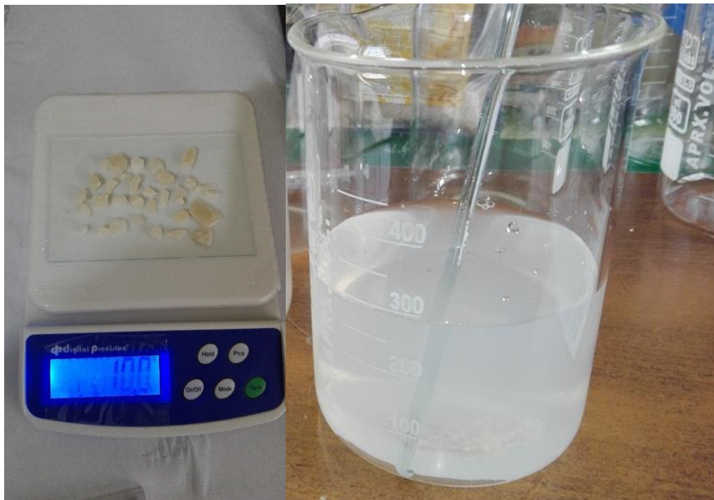
ILUSTRACIÓN N° 16: 10 GRAMOS DE SULFATO DE ALUMINIO EN UN LITRO (SOLUCIÓN)
