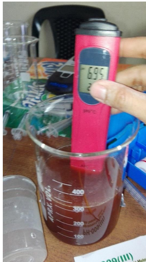
ILUSTRACIÓN N° 12: EL PH ES 6.95 DE LA MUESTRA DEL EFLUENTE CAMAL MUNICIPAL EL PORVENIR CON PHI METRO DE BOLSILLO.
