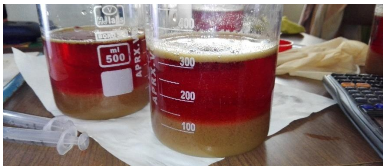
ILUSTRACIÓN N° 19: DOS FASES EN EL TRATAMIENTO CON SULFATO DE ALUMINIO AL 1% EL 7 DE OCTUBRE DEL 2017
