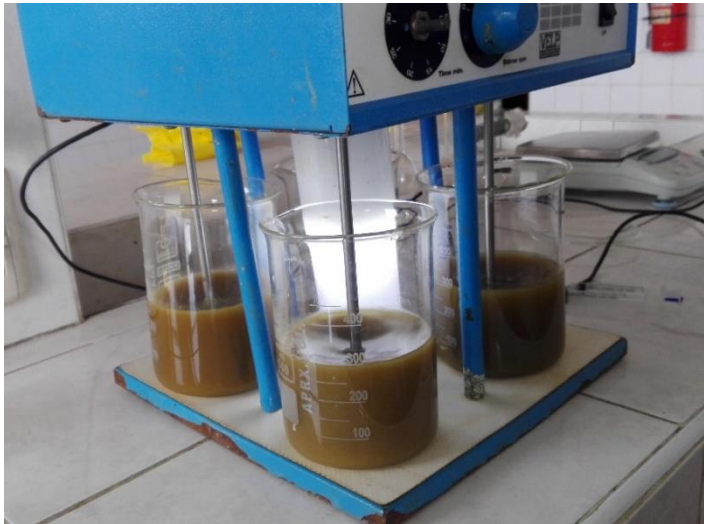
ILUSTRACIÓN Nº 8: TEST DE JARRAS -COAGULACIÓN SULFATO DE ALUMINIO AL 1% EL 7 DE OCTUBRE DEL 2017
