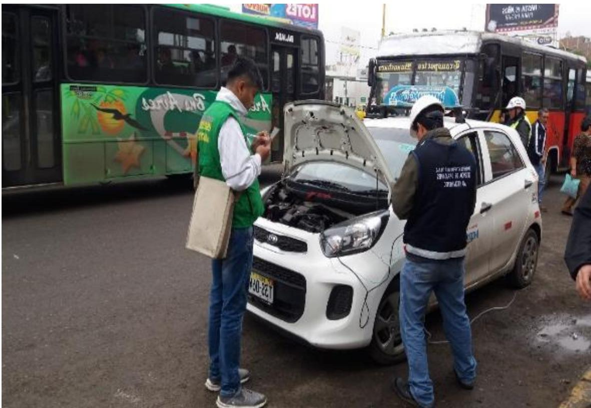
Anexo 11. Instalación del equipo que permite analizar emisiones vehiculares.
