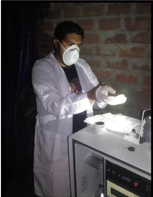
Empleando protección de barrera para proteger los filtros y equipo de contaminación
