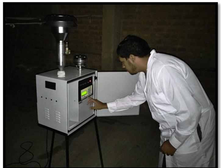
Programación del Low-Vol para la medición respectiva de 24h
