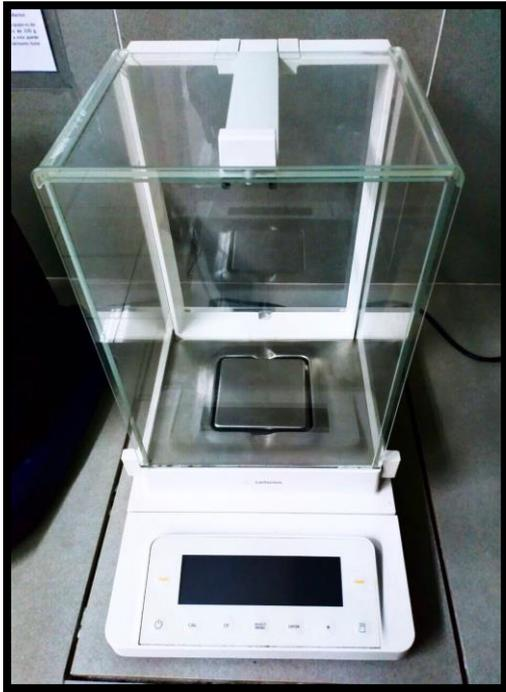
Balanza analítica usada para los pesajes de filtro
