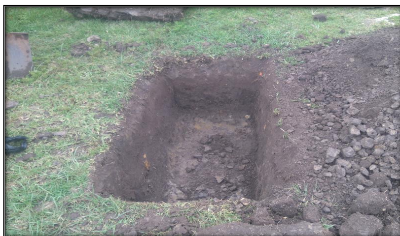
Figura 23: Otra de las calicatas realizadas. Fuente: Tesista
