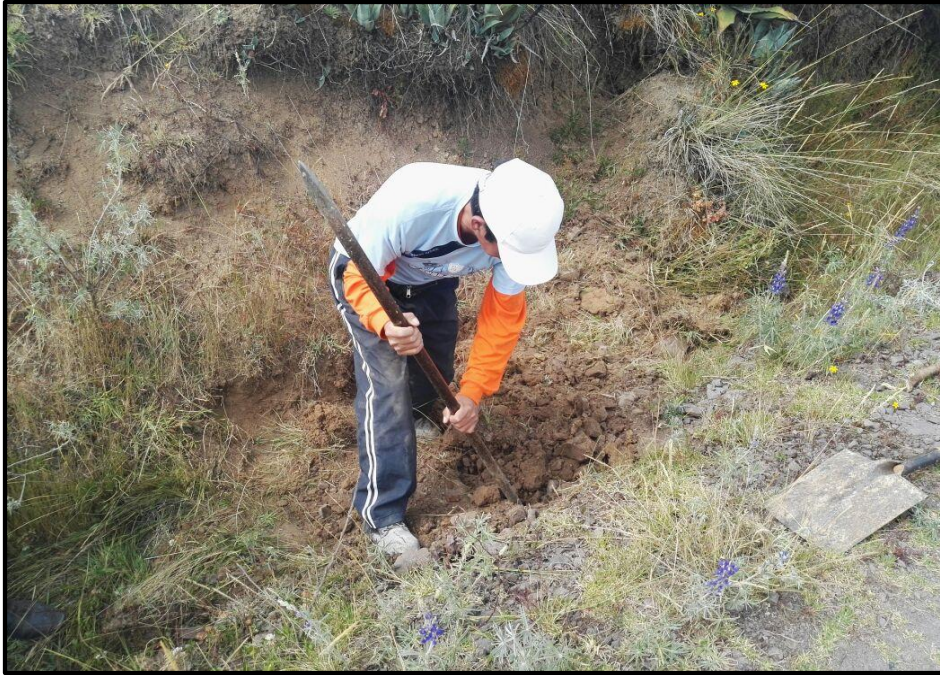
Anexo N° 18 Realizando las calicatas para obtener las muestras necesarias para el estudio de suelos respectivo.
