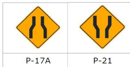
Figura N° 46 SEÑALES PREVENTIVAS POR RESTRICCIONES FÍSICAS DE LA VÍA
