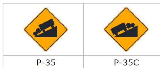
Figura N° 45 SEÑALES PREVENTIVAS – PENDIENTE LONGITUDINAL
