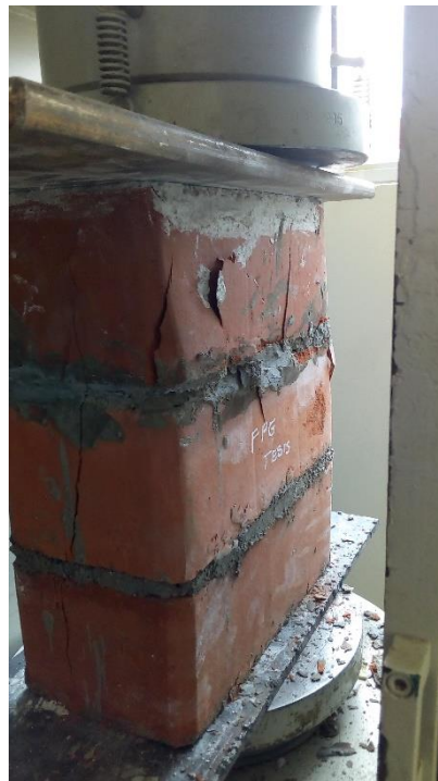
Figura 12. Falla de la pila patrón(P0)
