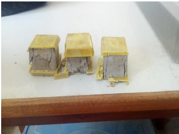
Figura 10. Especímenes de mortero patrón después de ensayo.
