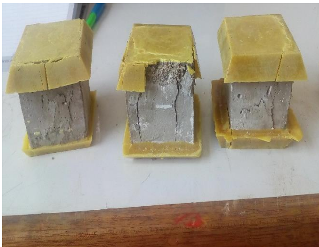
Figura 11. Especímenes de mortero con 2% de clara de huevo.
