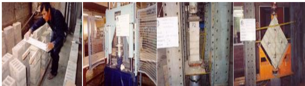
a. Capeado con yeso a pilas b) cubo de mortero ubicada en la máquina de ensayo. C) Pila colocada en la máquina de ensayo d) murete colocada en la máquina de ensayo.
