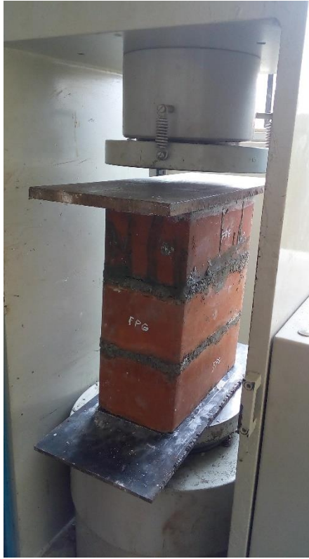
Figura 7. Pila de albañilería ubicada en la máquina de ensayo.
