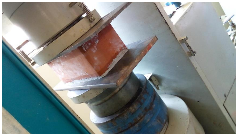
Figura 15. Ubicación en la máquina de ensayo a la unidad de albañilería
