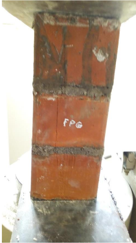
Figura 13. Falla de la pila con 2% de CDH
