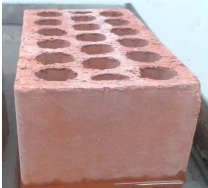
Figura 6. Proceso de succión de la unidad de albañilería
