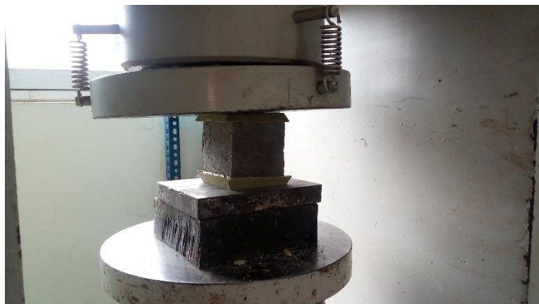
Figura 4. Especimen cubico centrada y ubicada en la máquina de compresión.
