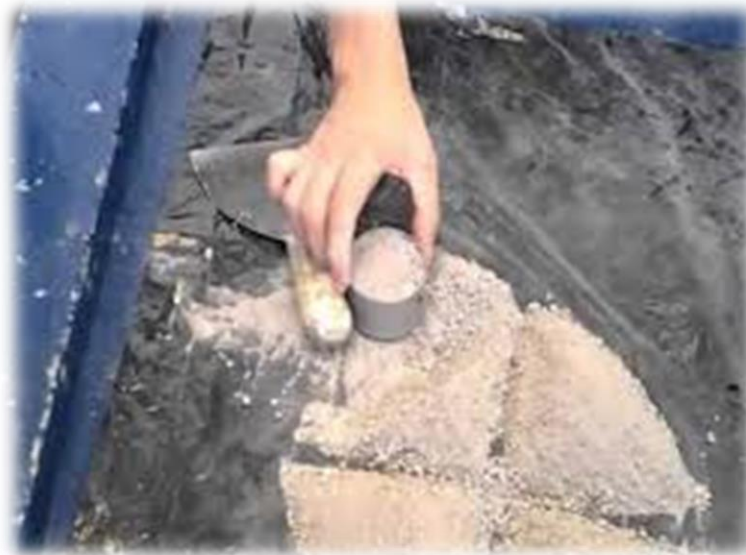
Figura III-13: Cuarteo de la muestra, para que después sea colocado en la probeta.
