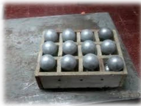
Figura III-26: Las 12 esferas que se coloca dentro de la máquina.
