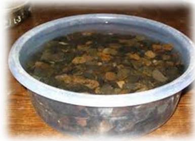
Figura III-33. Agregado grueso sumergido en sulfato de magnesio.
