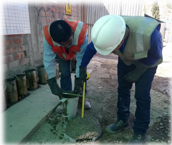
Figura III-42: Ensayo de asentamiento (SLUMP).
