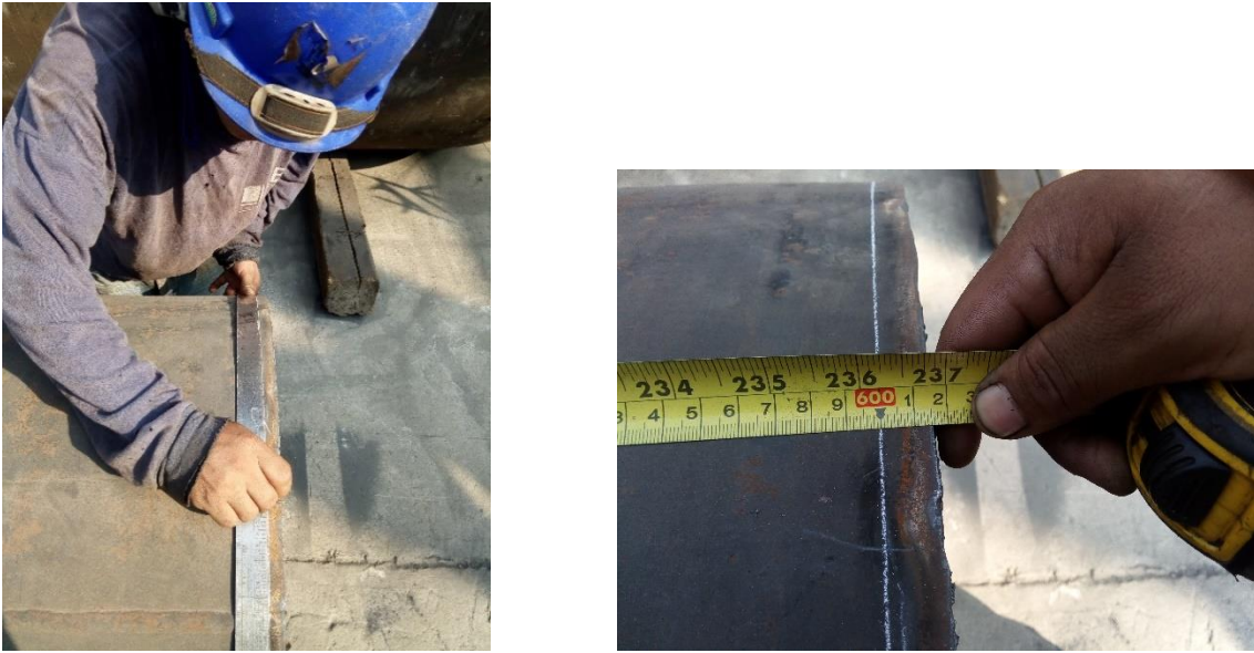
Figura N° 40: Trazado de tubería
